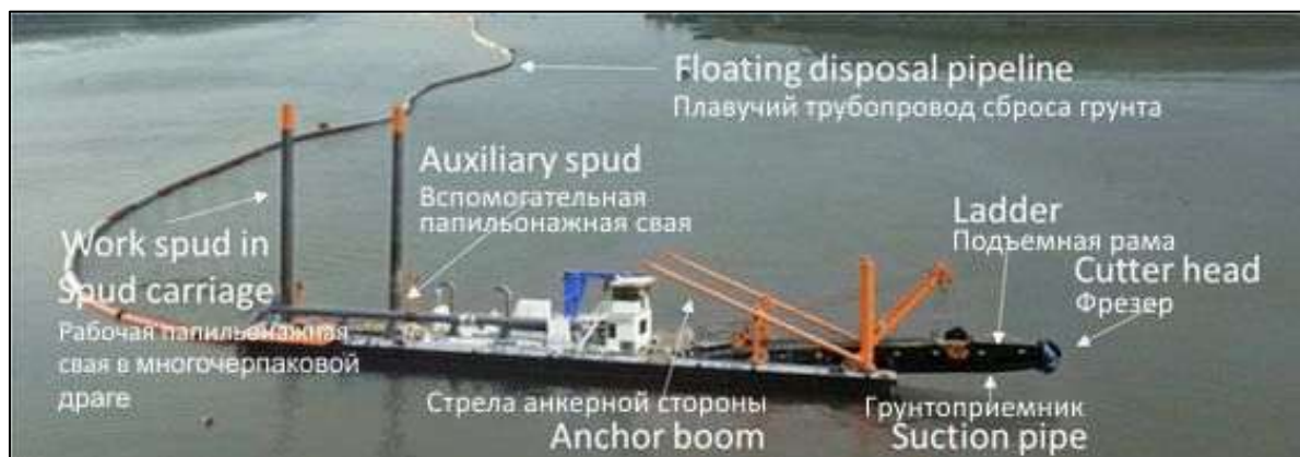
Рисунок 1.8 Фрезерный земснаряд
