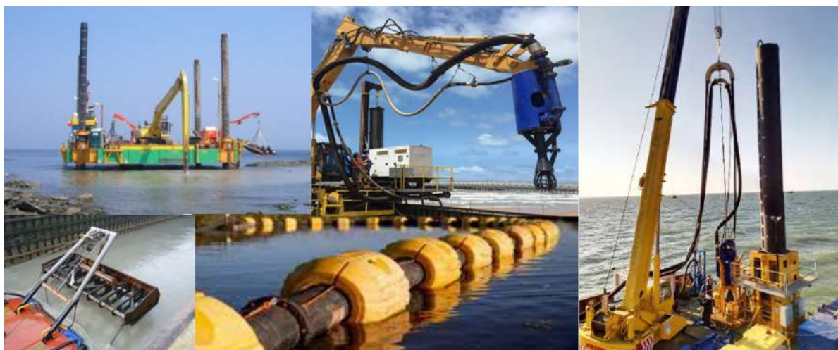
Рисунок 1.7 Мобильный кран на плавучей самоподнимающейся платформе с насосом DOP
