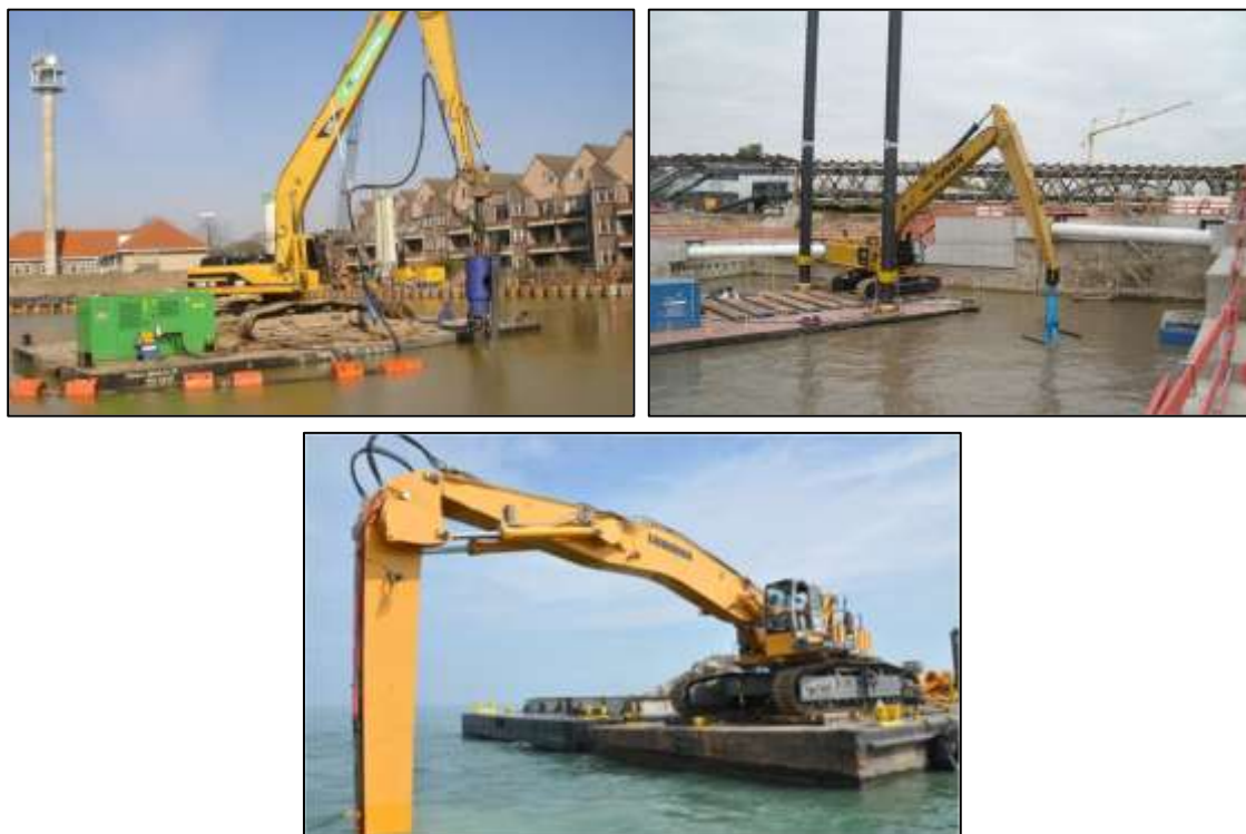
Рисунок 1.10 Механический земснаряд (МЗ) снизу, оснащенный ПЗС (слева) или грейферным ковшом (справа)
