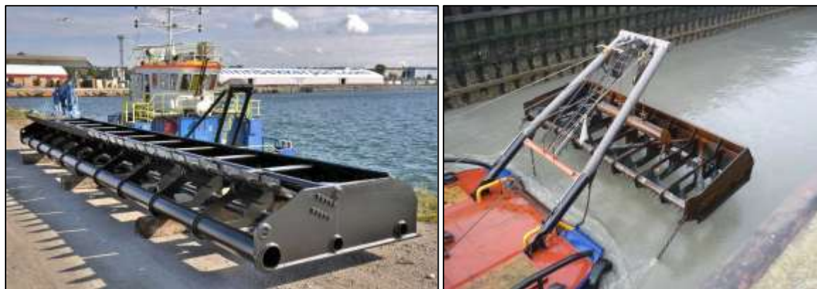
Рисунок 1.9 Плуг (слева) и плуг, подвешенный на раме на корме буксирного судна (справа)
