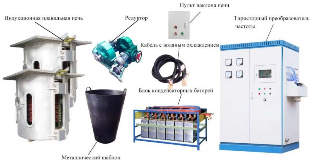
Рис.2 – Основные элементы индукционной плавильной установки
