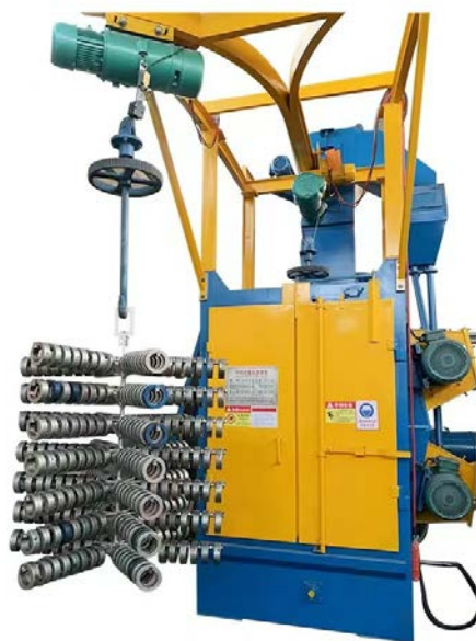
Рис.5 Подвесная дробеметная машина тупикового типа
