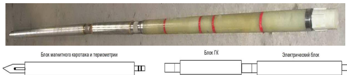
Рис. 5. Каротажный скважинный снаряд ПРК-4203
