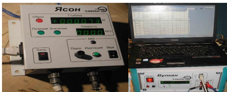
Рис. 6. Наземная регистрирующая аппаратура для ПРК-4203
