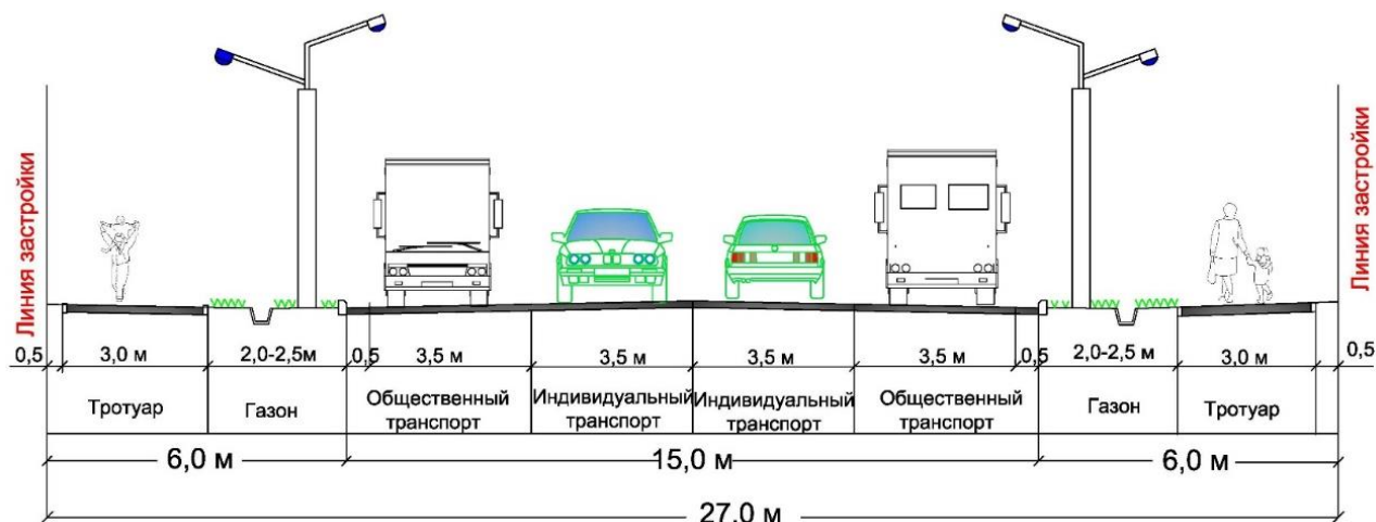
Рис. 3.1. Типовой поперечный профиль участка ул. Тимирязева от ул. Байтурсынова до ул. Желтоксан
