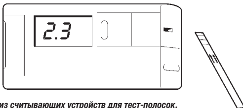
Одно из считывающих устройств для тест-полосок. Тест-полоска вставляется в щель на правой стороне устройства
