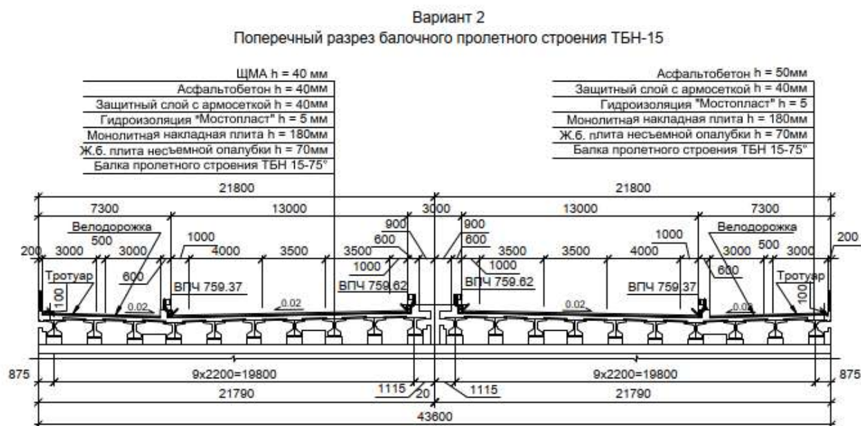
Рис. 3.5. Поперечный разрез пролетного строения ТБН-15. Вариант 2
