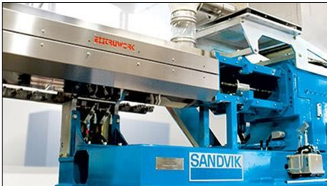
Фото 2.1 Установка грануляции по технологии «Ротоформ» компании «Сандвик»
