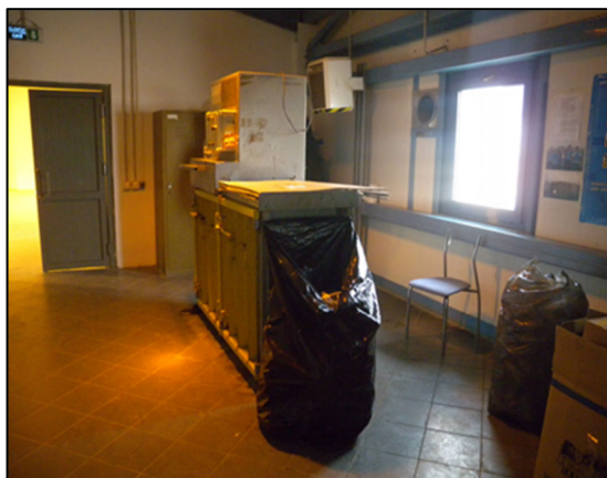
Рисунок 3.4 Канальный пресс для прессования отходов бумаги и картона, отходов пластика
