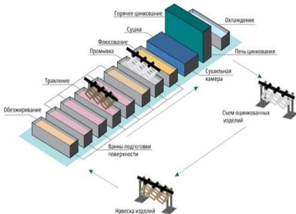
Технологический цикл цинкования
