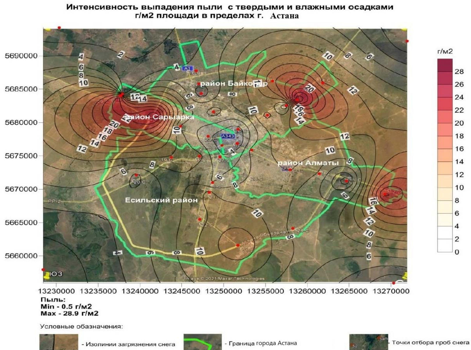
Рис. 11 Карта интенсивности выпадения пыли с твёрдыми и влажными осадками на территории города
