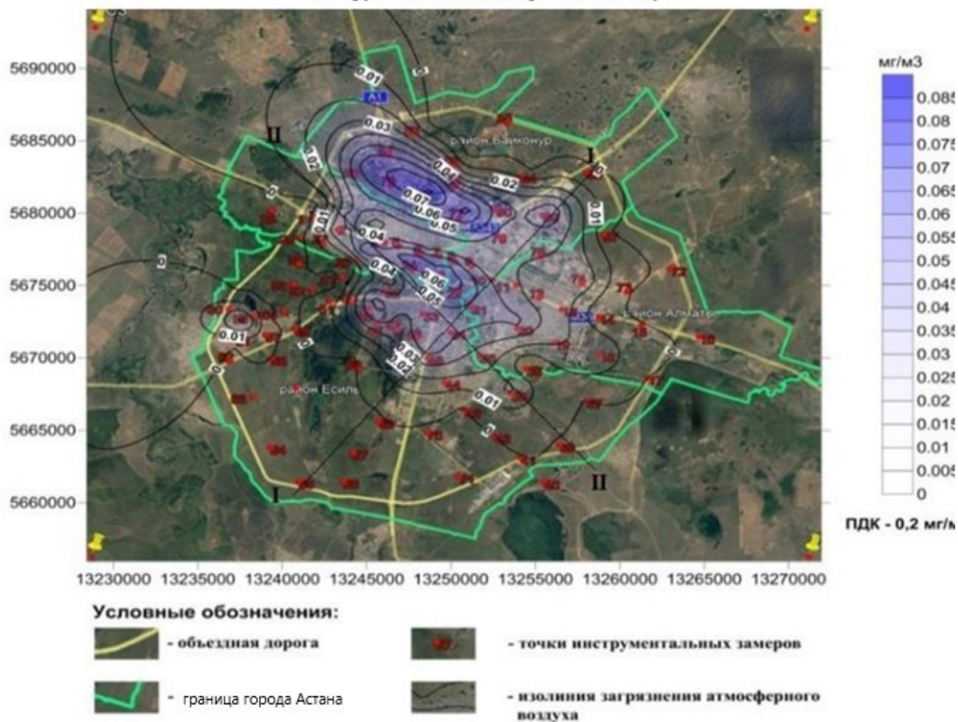
Рис. 3. Карта содержания диоксида азота с точками инструментальных измерений концентрации на территории города Астана
