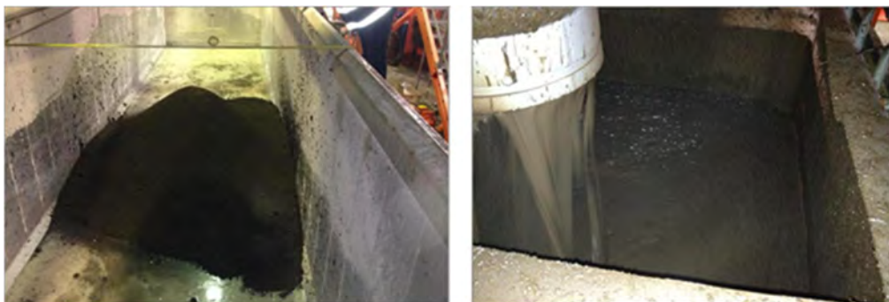
Фото 40 Разделенные фазы бурового шлама – буровой раствор и сухой осадок
