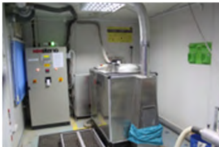
Фото 30 Установка для обезвреживания медицинских отходов – «Ньюстер 10»
