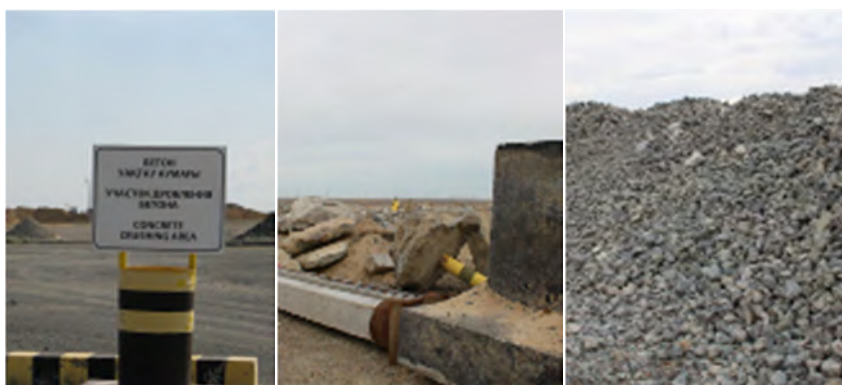
Фото 6 Площадка накопления бетона до и после крошения
