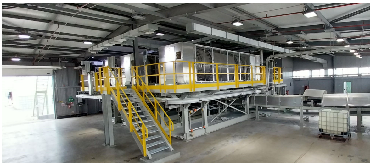
Фото 2 Мобильная установка грануляции серы GX
