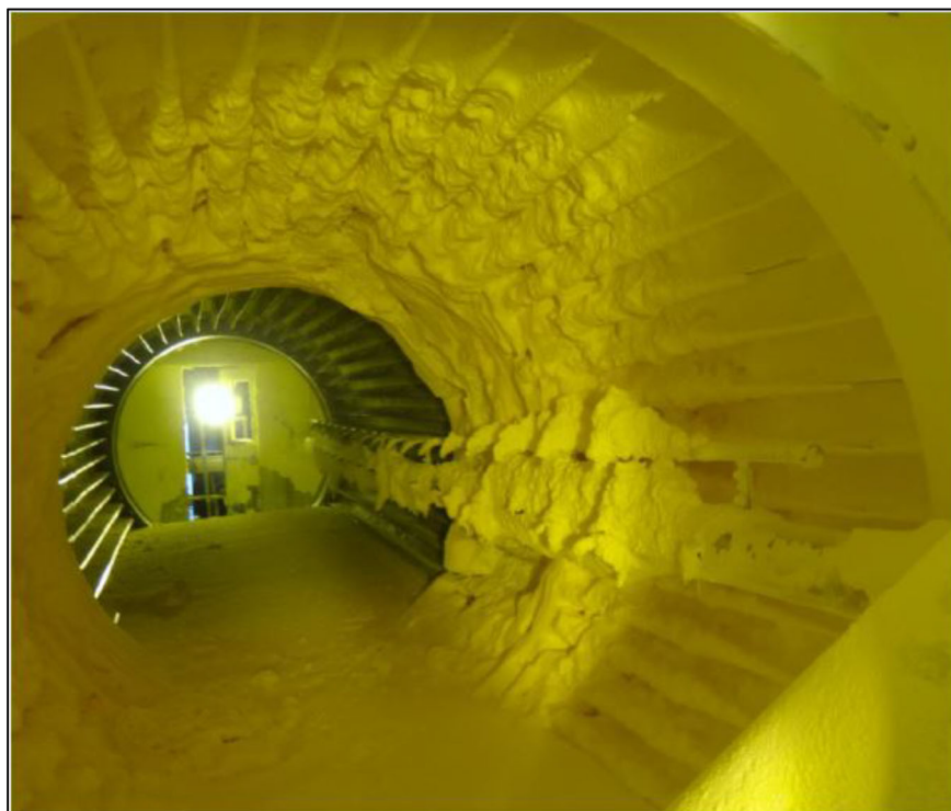
Фото 5 Состояние барабана грануляции при сбоях технологического режима
