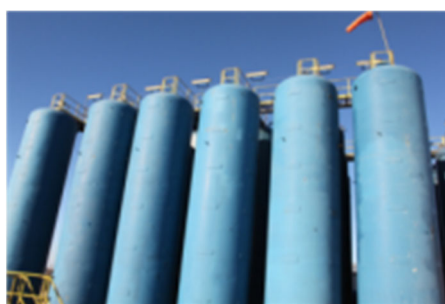
Фото 40 Хранение базового масла, полученного в процессе очистки бурового раствора
