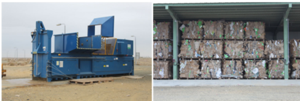
Фото 32 Пакетировочный пресс WHS 650 HDE и спрессованный картон после пресса в виде брикетов на ТЭЦ
