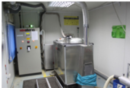
Фото 31 Установка для обезвреживания медицинских отходов – «Ньюстер 10»
