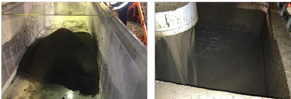
Фото 41 Разделенные фазы бурового шлама – буровой раствор и сухой осадок
