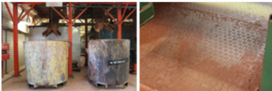
Фото 37 Процесс очистки бурового раствора на установках ENVIROCENTER
