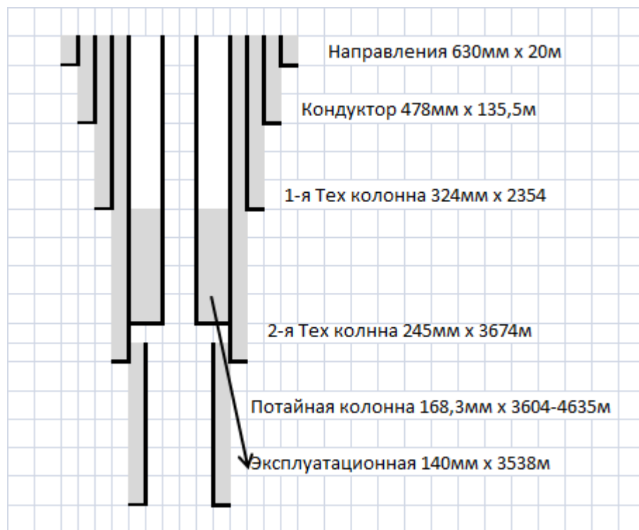
Рисунок 4 - Конструкция скважины Южная-1
