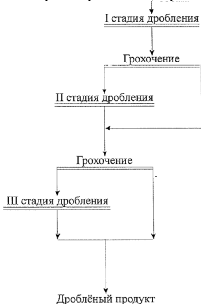
Рисунок-8.1 Принципиальная схема дробления руды
