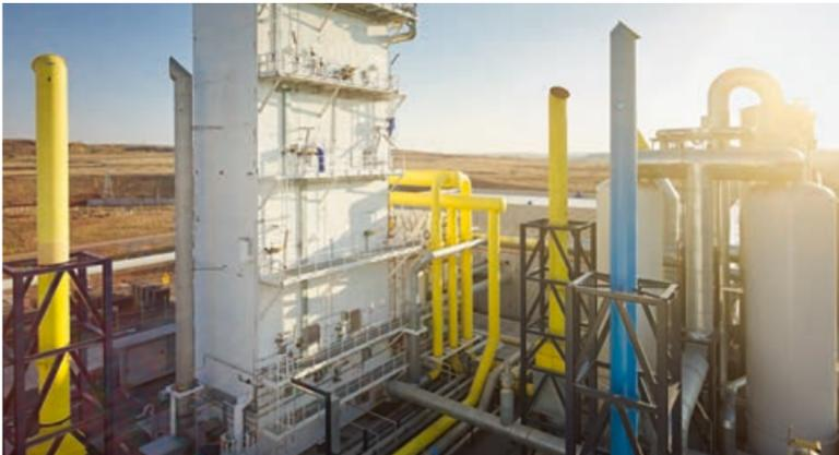
Luftzerleger-Anlage, gebaut von Linde in Temirtau, Kasachstan.
