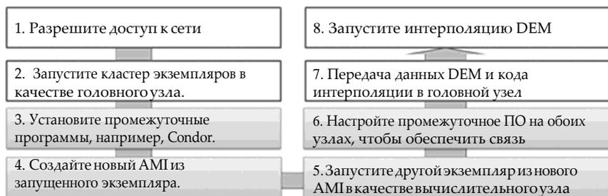
Рисунок 5.9 (См. цветную вставку.) Процесс настройки системы НРС для запуска интерполяции DEM на EC2 (серые прямоугольники указывают дополнительные шаги для настройки виртуальной среды НРС).
