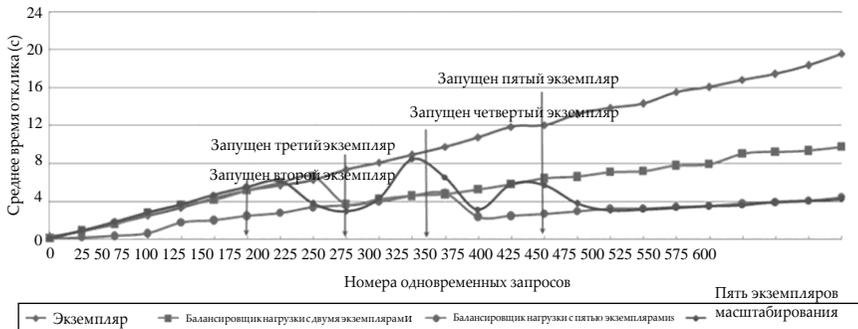
Рисунок 16.6 Сравнение производительности отклика CLN для экземпляров с одной, двумя и пятью загрузками и пяти экземпляров с автоматическим масштабированием. (Yang et al., 2011a.)
