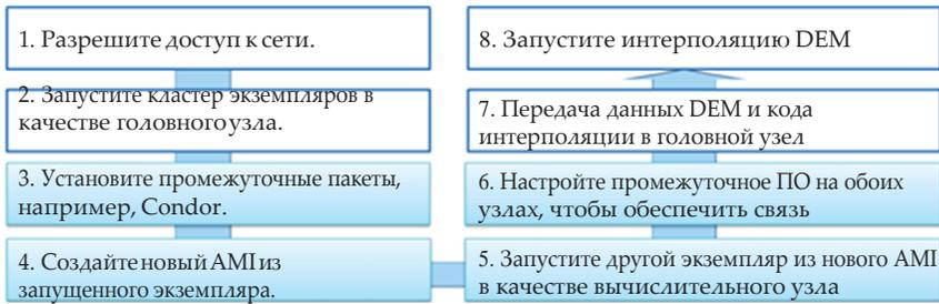
Рисунок 5.9 Процесс настройки системы НРС для запуска интерполяции матрицы высот на ЕС2 (синие прямоугольники указывают дополнительные шаги для настройки виртуальной среды НРС).
