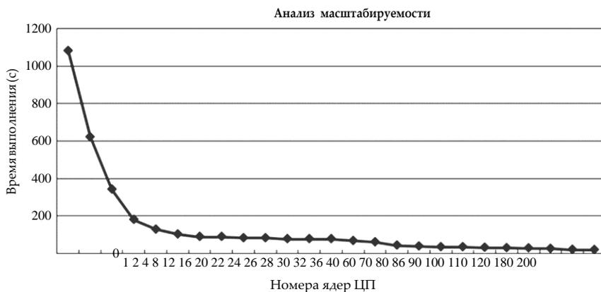
Рисунок 16.1 Интерполяция DEM с параллельной обработкой CPU.
