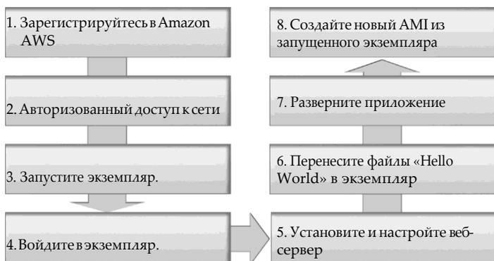
Рисунок 4.3 Процесс развертывания Hello Cloud на Amazon EC2.
