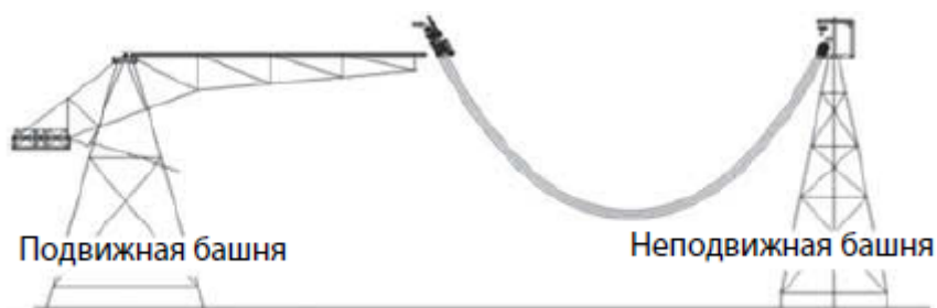
Рисунок 5.3 Гибкий шланг, используемый в системе перекачки СПГ [3].
