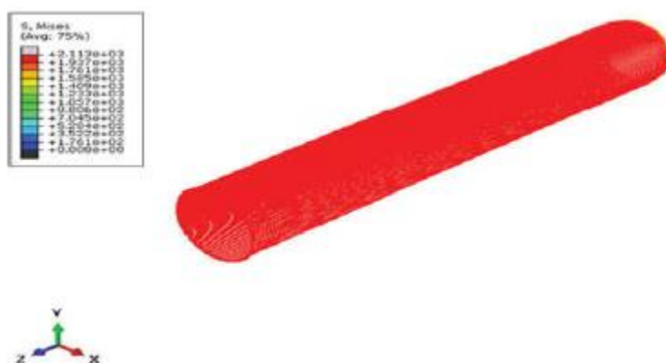
Рисунок 35.13 Распределение напряжения в бездефектной трубе.
