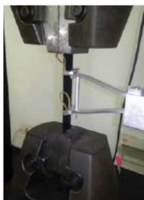
(a) Испытание на растяжение стальной ленты
