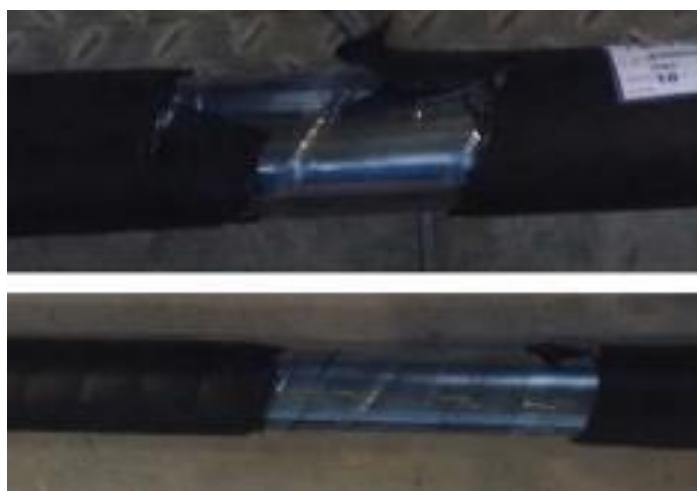
Рисунок 16.18 Режим разрушения наружного полиэтиленового слоя.
