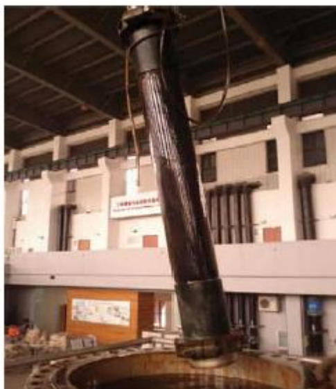
Рисунок 32.11 Перекошенная PSP труба после эксперимента на сопротивление давлению.
