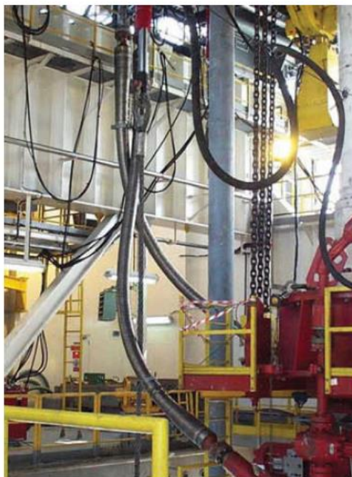
Рисунок 23.10 Устьевая обвязка для дросселирования и глушения скважины, установленные на самоподъёмной буровой установке Ensco 101.
