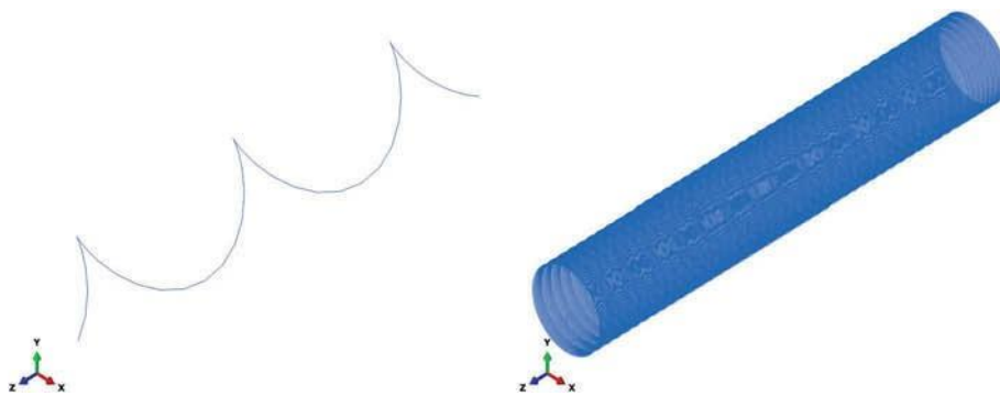
Рисунок 27.9 Кевларовые провода в ABAQUS.
