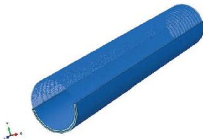
Рисунок 34.4 Конечно-элементная модель связанной гибкой трубы из стальной проволоки
