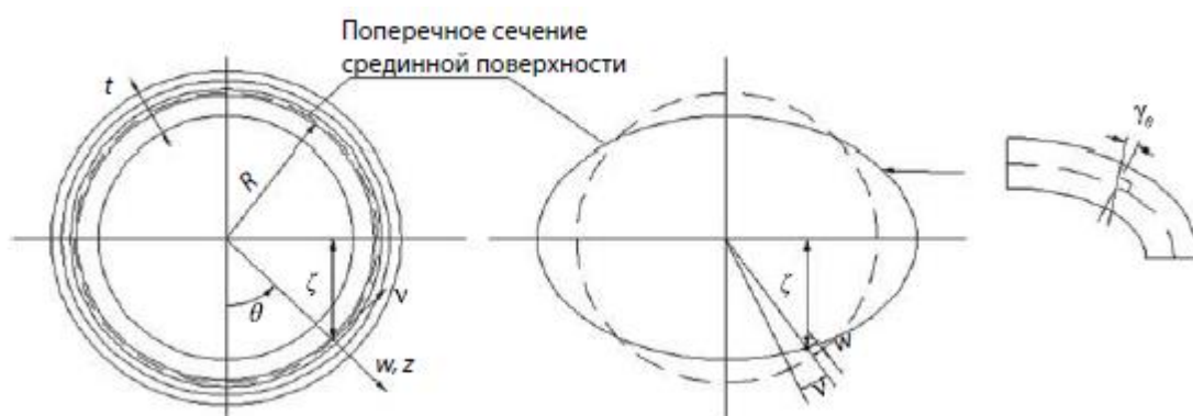
Рисунок 26.2 Деформация поперечного сечения
