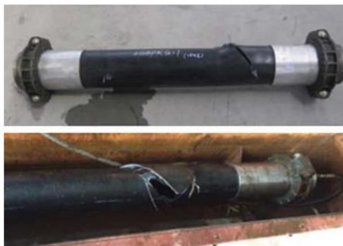
Рисунок 31.11 Режим отказа образцов под внутренним давлением.
