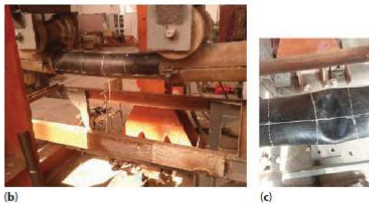
Рисунок 33.8 Схема (а), экспериментальное фото (б) и точка изгиба (в) испытания на изгиб.
