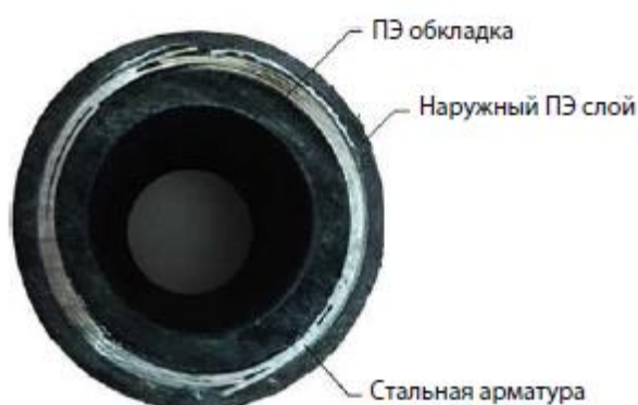
Рисунок 1.8 Типовая конструкция несвязанной FCP (фото предоставлено компанией «OPR Inc.»)
