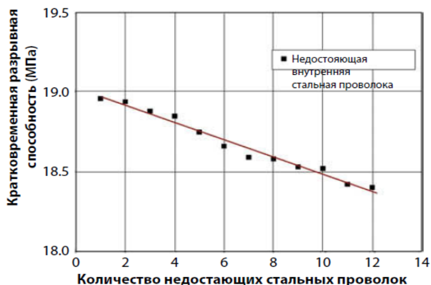
Рисунок 35.9 Влияние отсутствия стальной проволоки на кратковременную разрывную способность.
