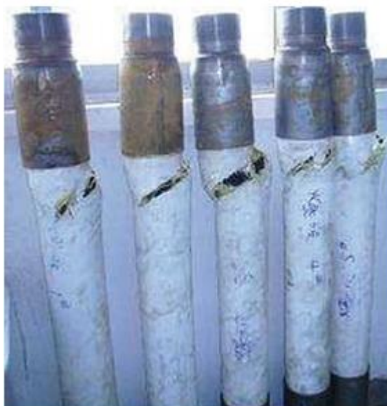
Рисунок 24.2 Образцы разрыва после испытания
