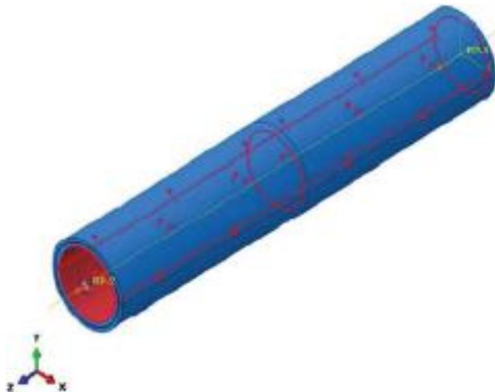
Рисунок 18.8 Ограничение и граничные условия на каждом конце трубы.
