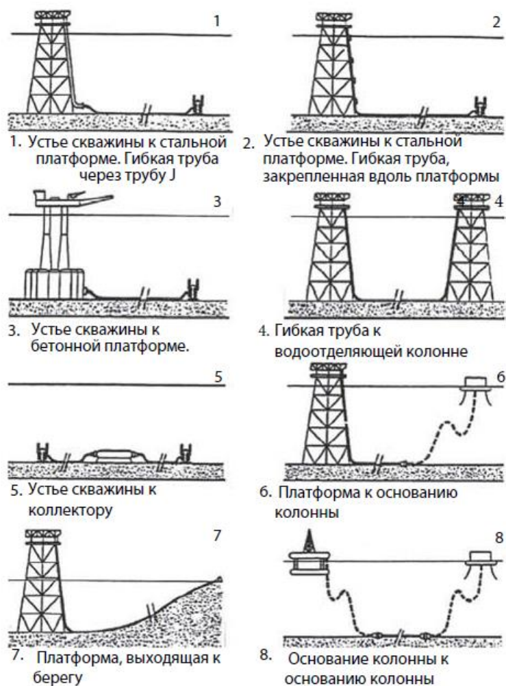
Рисунок 5.2 Конфигурация выкидного трубопровода [2].
