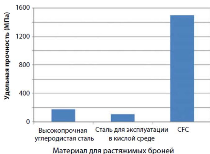
Рисунок 5.10 Удельная прочность различных материалов, используемых для растяжимой брони [7].
