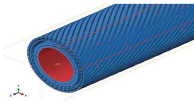
Рисунок 11.1 Три слоя с растягивающимся слоем брони.
