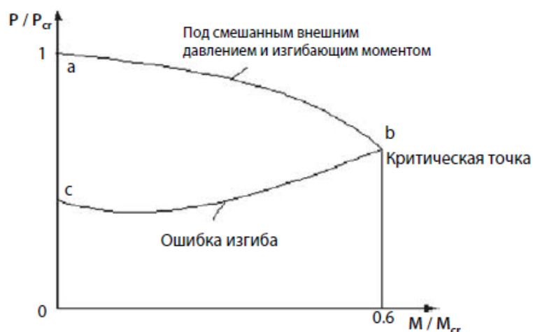
Рисунок 28.17 Приближительное взаимодействие объема смятия на RTP
