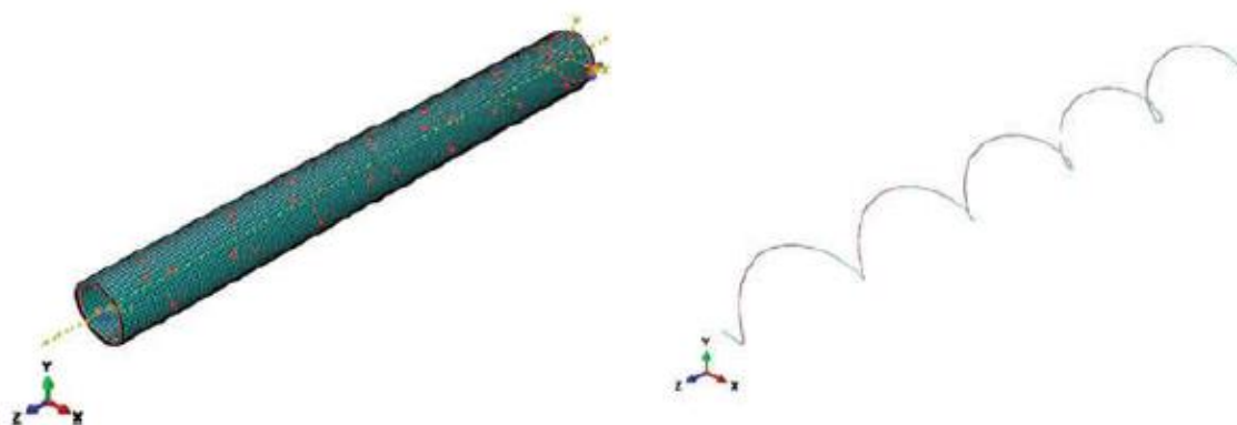
(а) Моделирование полимерно-армированной трубы из стальной проволоки
