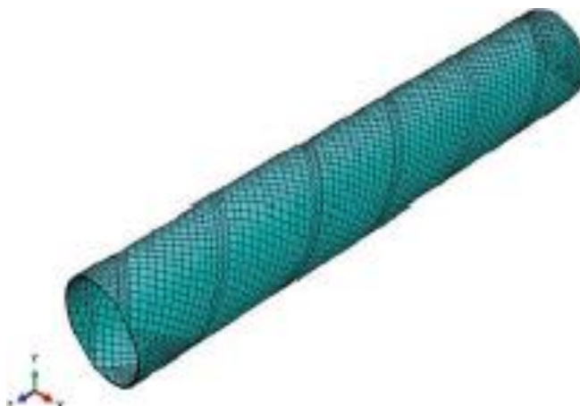
Рисунок 19.4 Создание сетки композитного слоя со стальной лентой.
