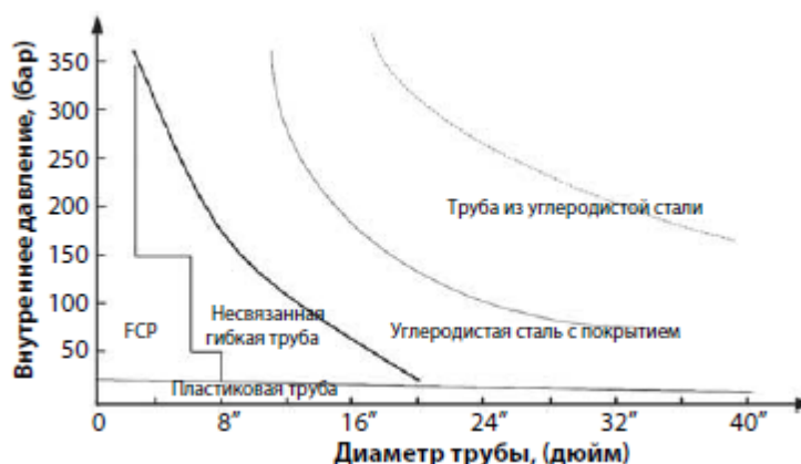
Рисунок 1.9 Диапазон применения гибких труб
