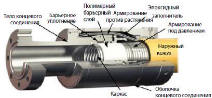
Рисунок 3.13 Типовое концевое соединение для несвязанных гибких труб [9]
