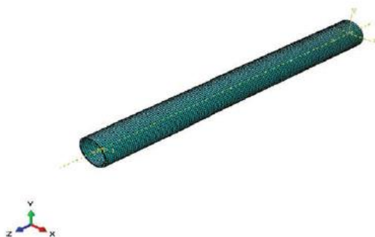
Рисунок 35.2 Модель сетки ABAQUS из связанной гибкой трубы из стальной проволоки.
