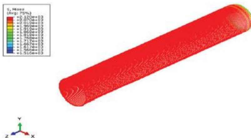
Рисунок 35.12 Распределение напряжений внутреннего слоя стальной проволоки.
