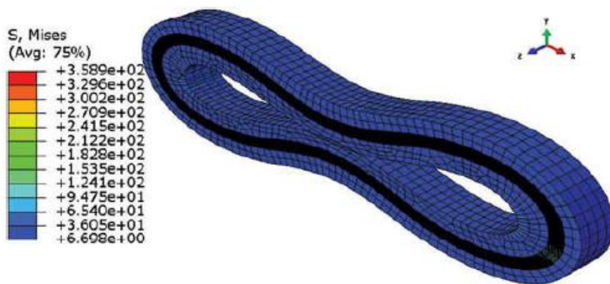
Рисунок 30.8 Деформация FGRFP при эксцентриситете стенки 0,0%.
