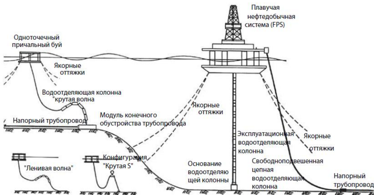
Рисунок 1.1 Конфигурации типичной гибкой водоотделяющей колонны
