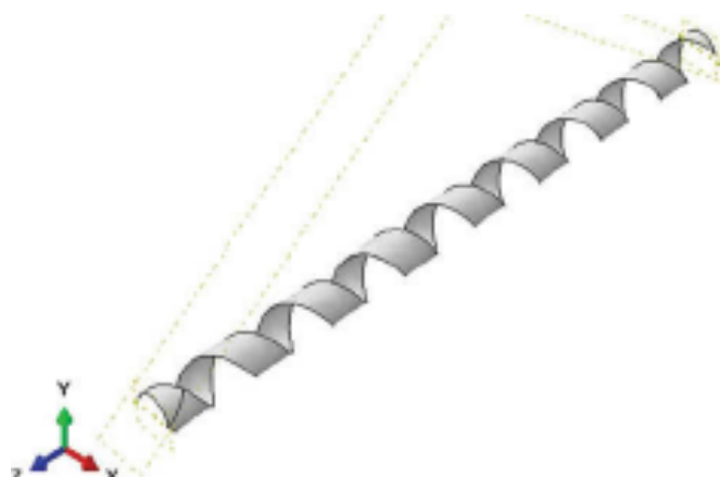
Рисунок 16.8 Армирующий слой из спирально намотанной стальной ленты.
