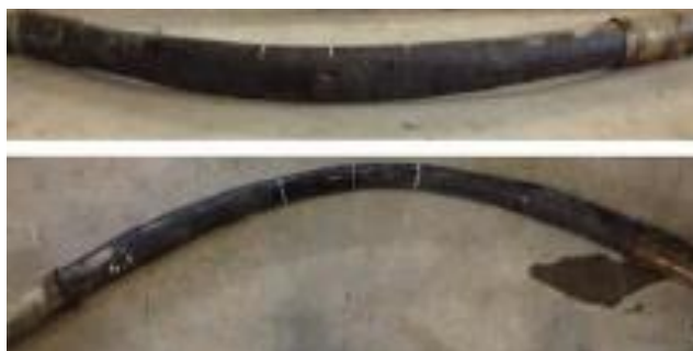
Рисунок 20.5 Смятие ГТАС с радиусом изгиба 1 м.
