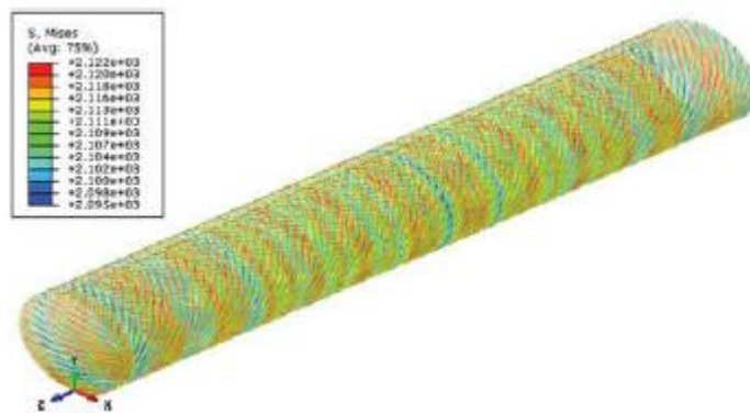
Рисунок 34.5 Давление разрыва связанной гибкой трубы из стальной проволоки, [МПа].
