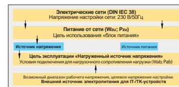
Рис. 4: Системные свойства блока питания
