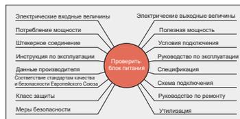
Рис. 2: Ментальная карта для испытания устройства
