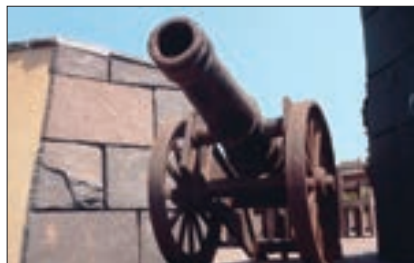
Рис. 2: Со времен Средневековья применяли чугунное литье. Формовку проводили во вращающихся деревянных моделях
