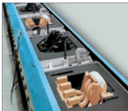
Рис. 3: Половинки форм со вставленными сердечниками в автоматической линии формования
