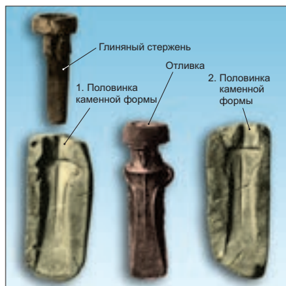
Рис. 1: Простейшие приспособления для формовки эпохи бронзового века (900–800 в. до н. э.): литейная форма для металлического топора
