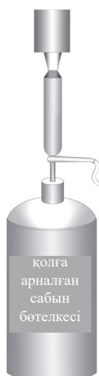
3.11-сурет Сорғы қысымымен контейнердің іске қосу күшін тексеру. Texture Technologies Corp. материалдар негізінде
