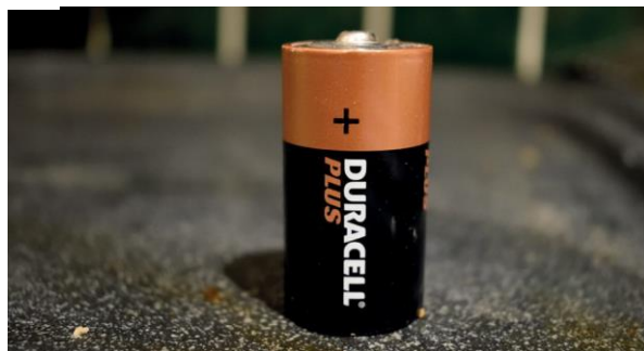
2.25-сурет Батарея электрохимиялық әсер арқылы жұмыс істейді
