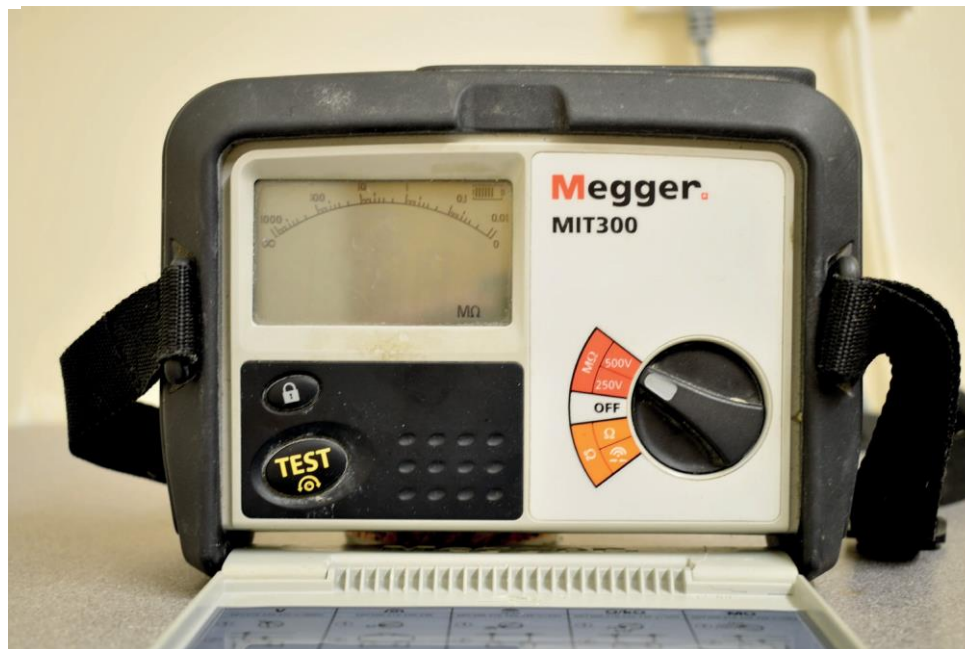
4.60-сурет М \Omega белгісі оқшаулауға төзімділікті білдіреді
