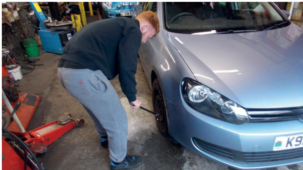
4.4 сурет. Шинаны ауыстырудың негізгі бөлігі доңғалақ гайкаларын қатайту үшін оңтайлы күш мөлшеріне орнатылған крутящий кілтті қолдануды қамтиды.
