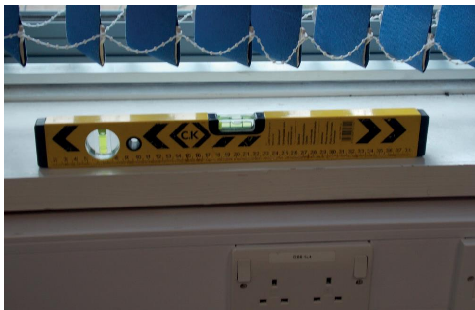
4.1 сурет. Рух деңгейлері жұмыс беттерінің немесе электр қондырғысының аспектілері параллель және біркелкі болуын қамтамасыз ету үшін өте пайдалы
