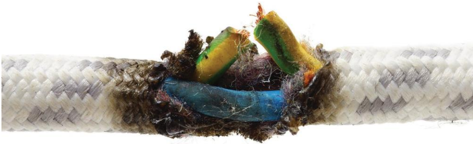
Сурет 1.24. Қызып кету электрлік қалпына келтіруге әкеледі
