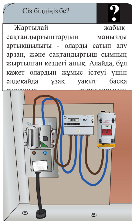
4.19-сурет. Негізгі қызмет көрсететін сақтандырғышқа кремний құмы кіреді, ол жеткізілімдегі кішігірім толқындарға төтеп бере алады
