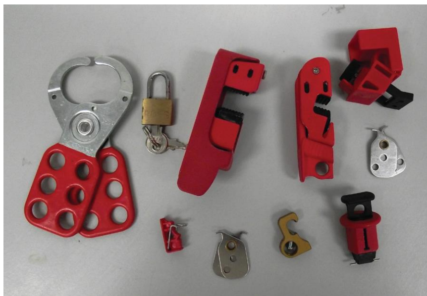
Сурет 1.27 Электр тізбегі электр тогының кездейсоқ қосылмауын қамтамасыз ету үшін жабық болуы керек
