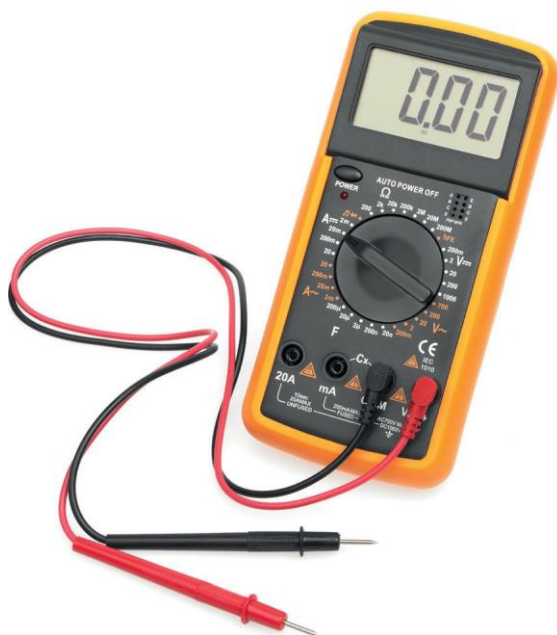
Сурет 2.41 Мультиметр кернеу, ток және кедергі сияқты әртүрлі өлшемдерді өлшей алады
