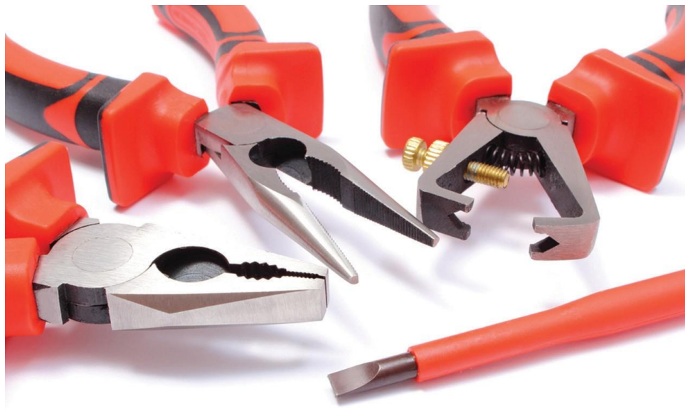
4.2 сурет. Электриктің құрал-сайманын ұзындығы бойынша окшаулау керек
