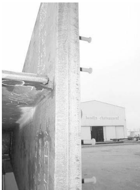
10.9 сурет. Екі еселенген V-тәрізді жиектемесі бар көпір арқалығы – Боден-Шатон нефтен алынған фотосурет
