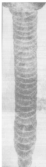
11.10-сурет 5GT қалпында орындалған вольфрамды дәнекерлеудің тар кесілген жиегінің макрографикалық пішіні
