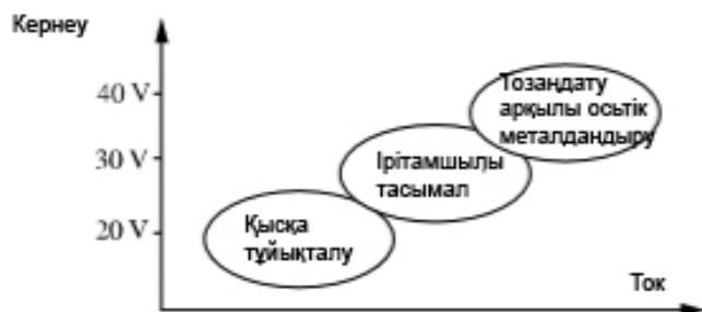
8.24-сурет. Балқитын электродпен имектеп дәнекерлеудегі ауысу түрлері Қысқа тұйықталу арқылы металды тасымалдау
