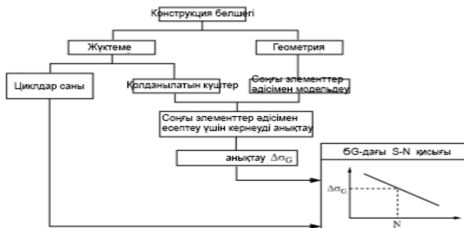
6.32. Сурет. Геометриялық кернеуде S-N қисығын анықтауға арналған рәсім (процедура)
