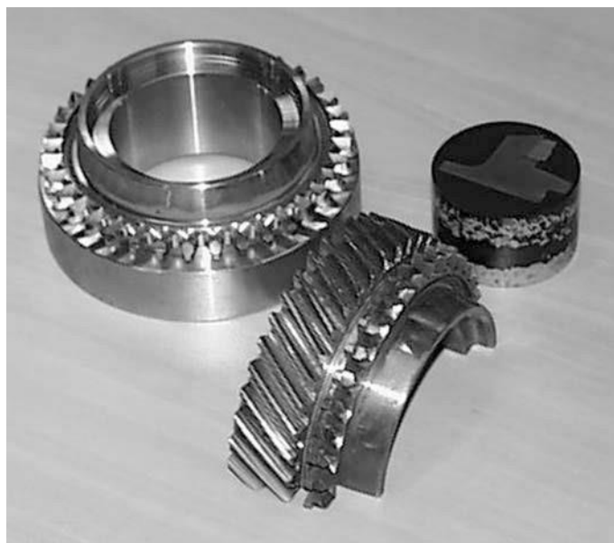
Сурет 9.3. Тістегершікке дәнекерленген, кесілген тістері бар немесе оларсыз жұдырықшалы муфтаның бейнесі.
