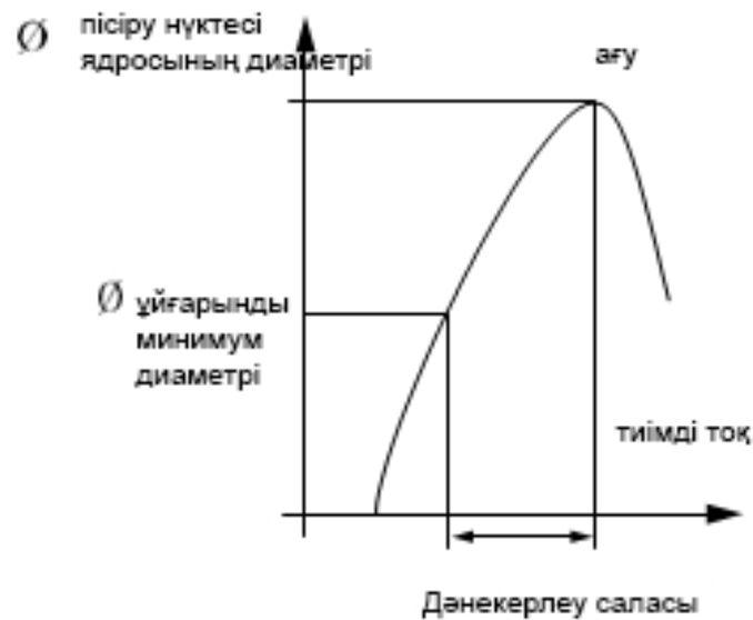
8.2-сурет. Дәнекерлеу жігі диаметрінің тиімді тоқ күшіне сәйкес сапалы өзгеруі
