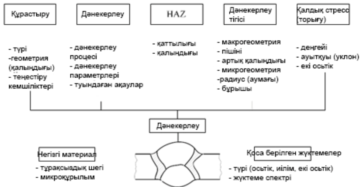
6.10. Сурет. Дәнекерлеген қосылыстардың қажу беріктігіне әсер етуші параметрлер
