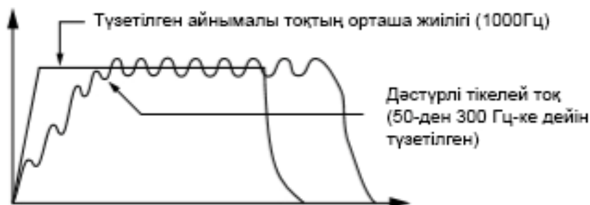
8.7-сурет. Дәстүрлі тұрақты және орташа жиілікті түзетілген айнымалы тоқтың толқындық диаграммасы
