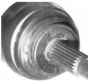
Сурет 9.1. Доғалы дәнекерленген кардан білігін және CV корпусын (алдыңғы дөңгелегі) шолу
