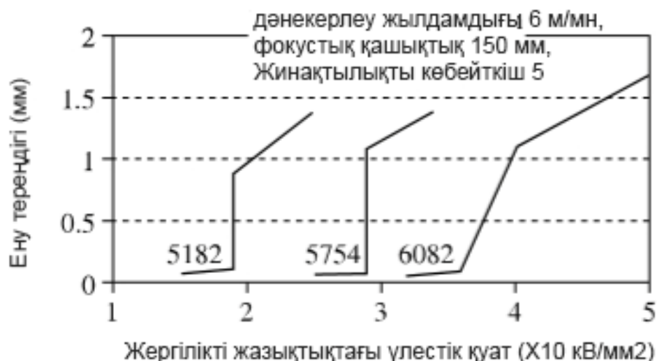
Сурет 13.10. Түрлі алюминий қорытпаларымен лазерлік өзара әрекеттесу шегі
