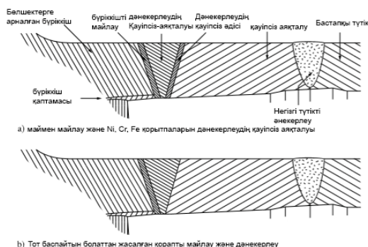
11.11-сурет Форсунканы/ құбырды біріктіру сызбасы
