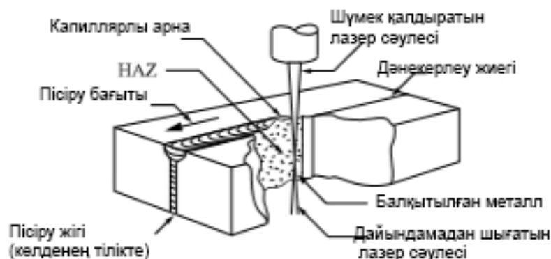
8.18-сурет. Дәнекерлеу жігі білікшесінің пайда болуы
