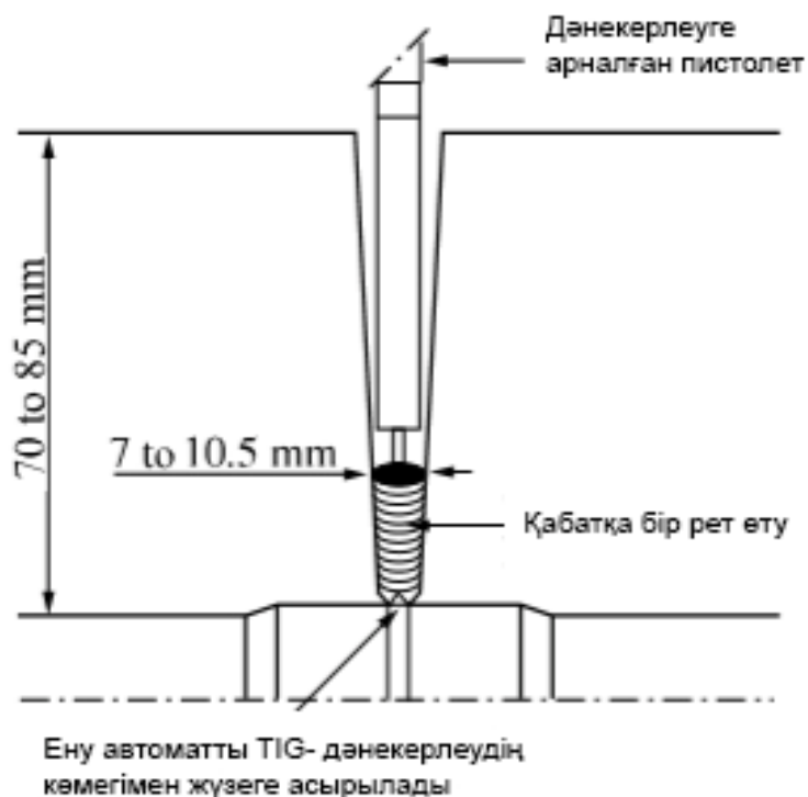
11.9-сурет Инертті газ ортасында вольфрамды электродпен орбиталдық доғалық дәнекерлеу үшін тар қисайтылған жиекті өзірлеу қағидасы
