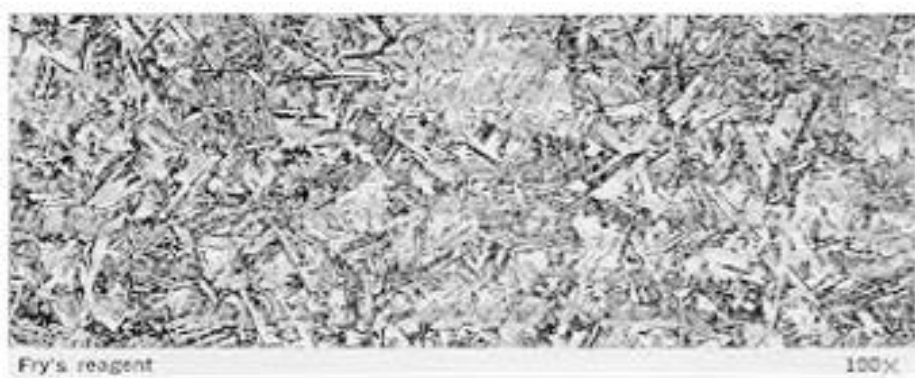
12.7-сурет AISI 630 EN 1.4542 мартенситінің құрылымы
