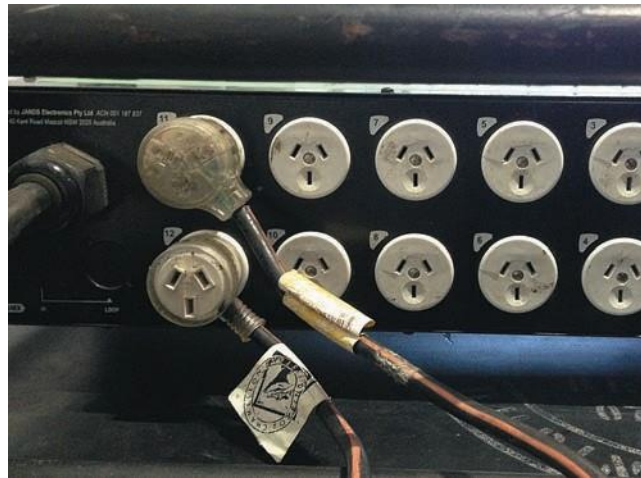
12.34-сурет. Бұл австралиялық қосқыштар тірі оқиғалар өндірісінде қолданылатын әртүрлі құрылғылар үшін қолданылады.
