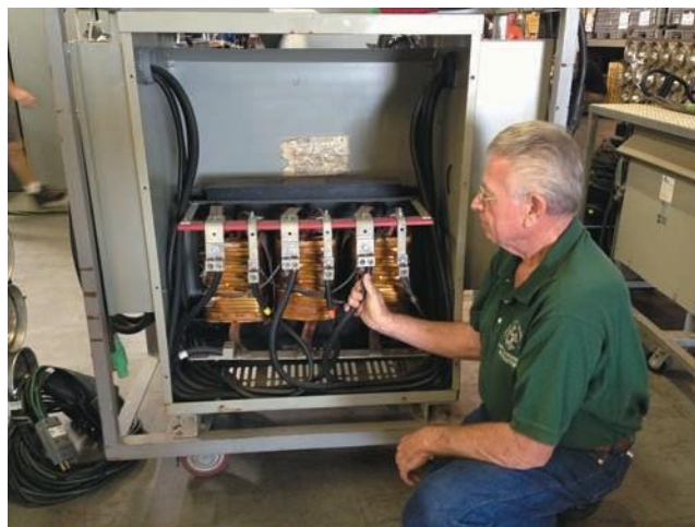
7.4-сурет 150 кВА коректендіргіш трансформаторының ішкі жағы үш жұп ораманы көрсетеді.
