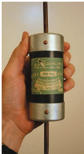
Сурет 10.2 Жоғары ажыратылатын сыйымдылықты жарғыш жүктемемен тізбекті ұзу кезінде туындайтын доғаны өшіру үшін кварц құмымен толтырылған.
