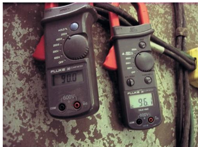
4.24-сурет. Синусоидалы емес толқындардың орташа өлшеуіштерін пайдалану қателіктер оқуға әкеледі. Бұл екі метр бірдей нәтиже көрсетпейді. Сол жақтағы өлшегіш - орташа оқу көрсеткіші, ал оң жақта - шынайы RMS метр. Дисплейдің астындағы «Шынайы RMS» деп аталатын затбелгіге назар аударыңыз.
