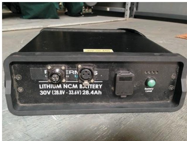
7.21 сурет Жарықдиодты шамдарды коректендіру үшін қолданылатын портативті литий- ионды аккумулятор. Бұл 28.4 Ah бейне түсіру немесе фильм күні бойы шағын панель Жарық диодын коректендіре алады.
