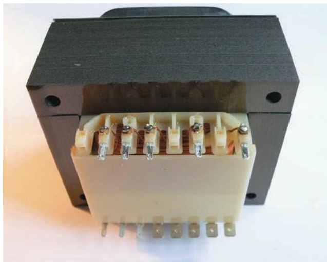
7.3-сурет Бұл трансформатордың шүмектері бар, олардың әрқайсысы шығыс кернеуін өзгертетін орамалардың тиімді санын өзгертеді.
