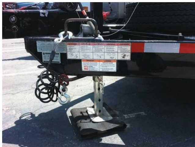
9.5 сурет Егер тіркемеде тасымалданатын генератор орнатылса осы суретте көрсетілгендей жерден оқшауланған, онда "кино және теледидар өнеркәсібінде портативті жабдықты жеткізетін портативті генераторлар үшін жерге қосу талаптарына" сәйкес, жерге қосу/ жерге қосу өзегі Лос-Анджелес аймағында талап етілмейді.
