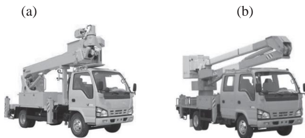
Рис 6.1 Подъемные устройства с изолирующими звеньями. (а) прямой тип стрелы; (б) складной тип стрелы.
