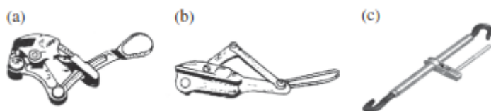
Рис. 4.8 Натяжитель (a) «косточка»; (b) «кузнечик», (c) натяжитель с двумя крючками.
