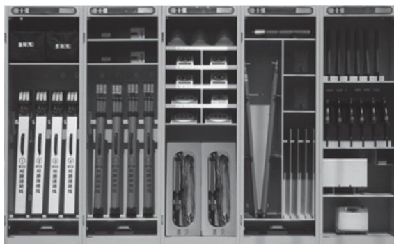
Рис. 4.15 Склад для инструментов для работы под напряжением. (a) склад для инструментов; (b) устройство специальных шкафов для электротехнических инструментов 1; (c) расположение специальных шкафов для электротехнических инструментов 2; (d) расположение специальных шкафов для изоляционных инструментов 3; (e) изолирующие экранирующие покрытие; (f) гараж с подъемным механизмом устройства с изолирующим звеном.
