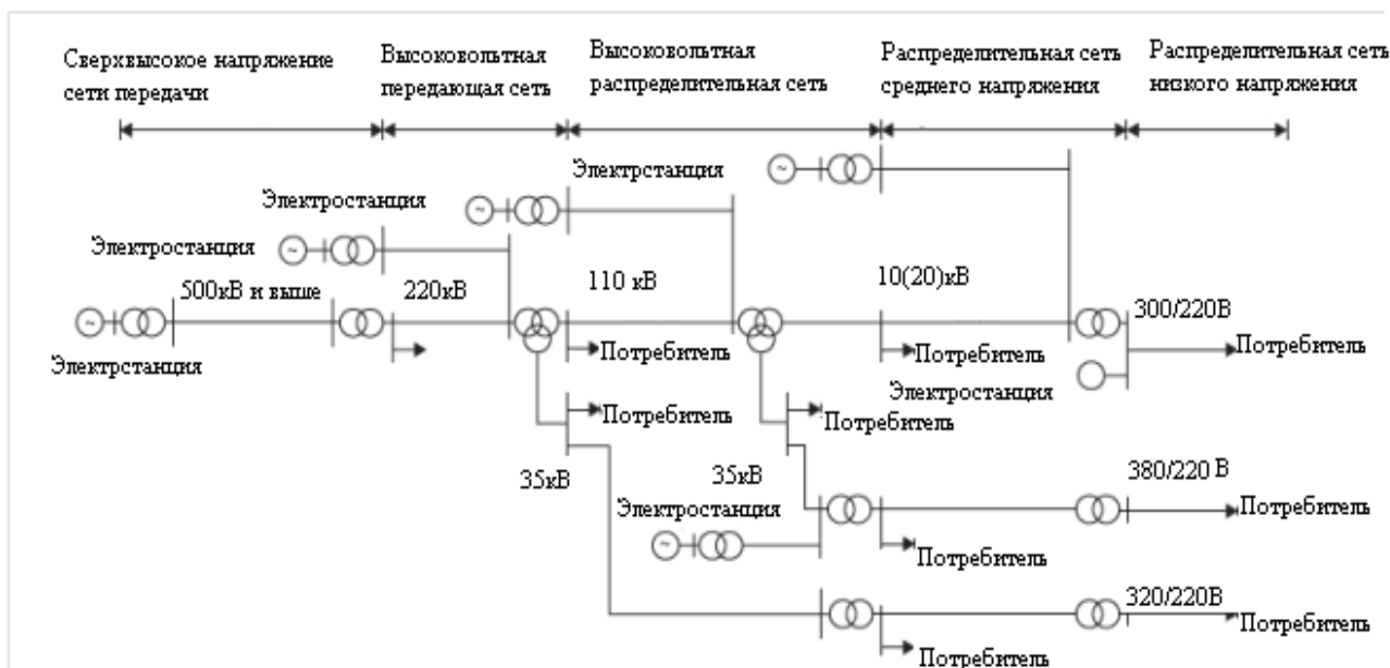
Рис. 2.1 Принципиальная схема разделения между передающими и распределительными сетями.
