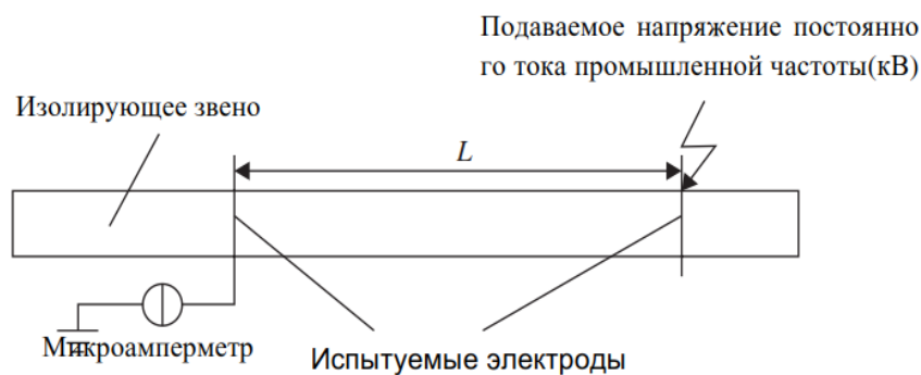
Рис. 6.8 Схематическое изображение проведения проверки тока утечки на изолирующем звене.
