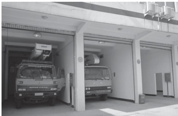
Рис. 6.4 Специальный гараж для подъемного устройства с изолирующим звеном.
