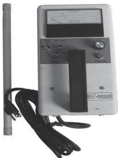
Рис. 4.12 Прибор для обнаружения токов утечки изолированной ручной штангой (включая щуп)
