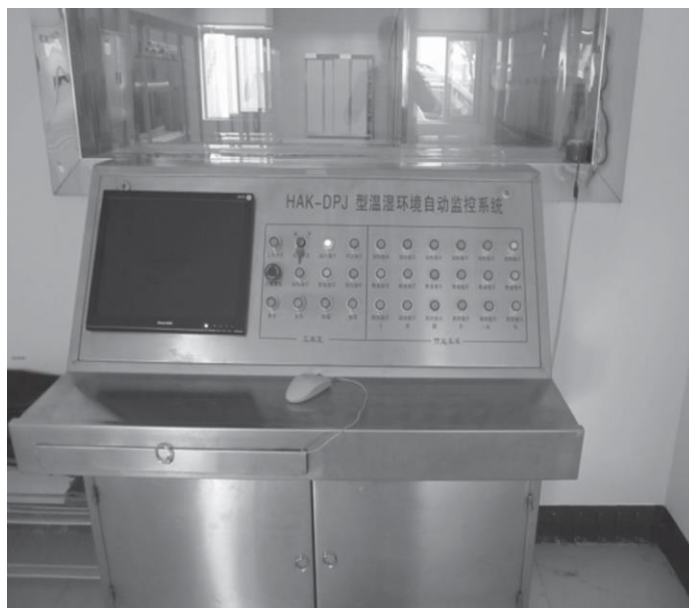
Рис. 4.14 Прибор для измерения и контроля температуры и влажности
