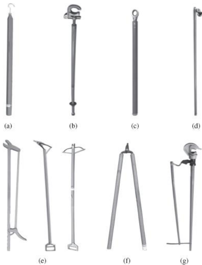
Рис. 4.1 Типовые изолирующие ручные штанги (a) изолирующая штанга; (b) изолированный крюк для проовда; (c) изолированный ключ; (d) изоляционное устройство для намотки; (e) изолированный зажим; (f) изолированный резак для провода; (g) изолированный гидравлический резак.
