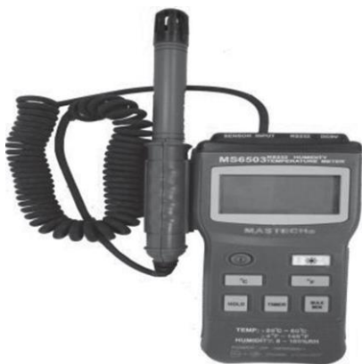
Рис. 4.13 Датчик температуры и влажности MS6503
