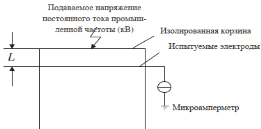
Рис. 6.6. Схематическое изображение проведения проверки тока утечки на изолированной корзине. L - расстояние между испытываемыми электродами.
