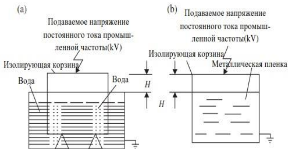
Рис. 6.5. Схематическое изображение проведения испытания изолированной корзины на устойчивость к напряжению промышленной частоты. (а) вода, находящаяся внутри и снаружи изолированной корзины (разборная); (б) металлическая пленка, обернутая внутри и снаружи изолированной корзины (закреплена) H - расстояние между верхней поверхностью изолированной корзины и поверхностью воды.
