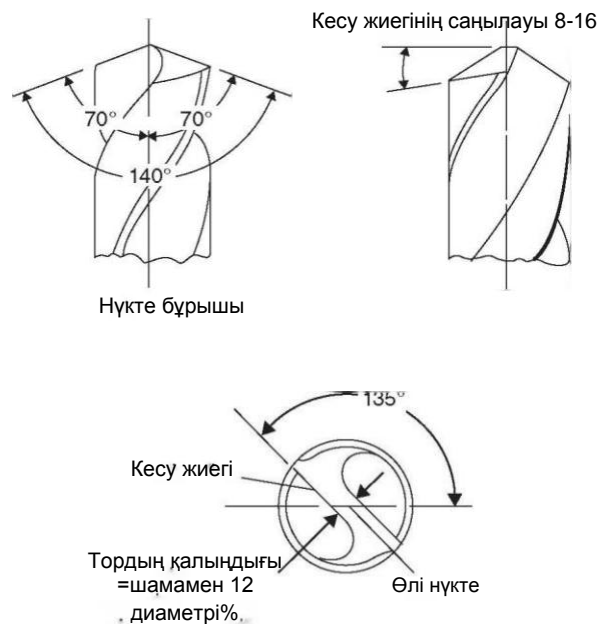
5.10 сурет. Тот баспайтын болатты бұрғылауға арналған ЖЖБ-бұрғылау геометриясы
