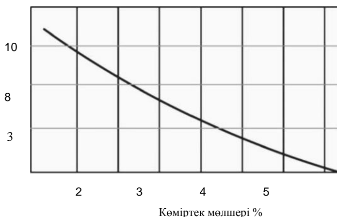
7.20-сурет. Көміртек мөлшерінің газ лазерімен бұрғыланған тесіктер бетінің кедір-бұдырлығына әсері. (Rykalin et al. алынды [17].)
