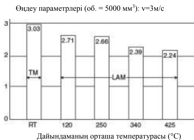
Сурет 9.3 Аустенитті ТБ Р550 өңдеуге арналған керамикалық құралдарды пайдалана отырып өңдеудің әр түрлі температуралары кезіндегі үлестік энергия.
