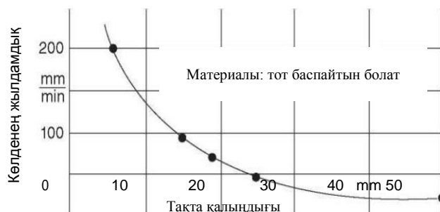
8.1-сурет. ТББ-тілімшесінің қалыңдығының АСАӨ-дағы орын ауыстыру жылдамдығына ықпалы. (Юсефиң [4] рұқсатымен)
