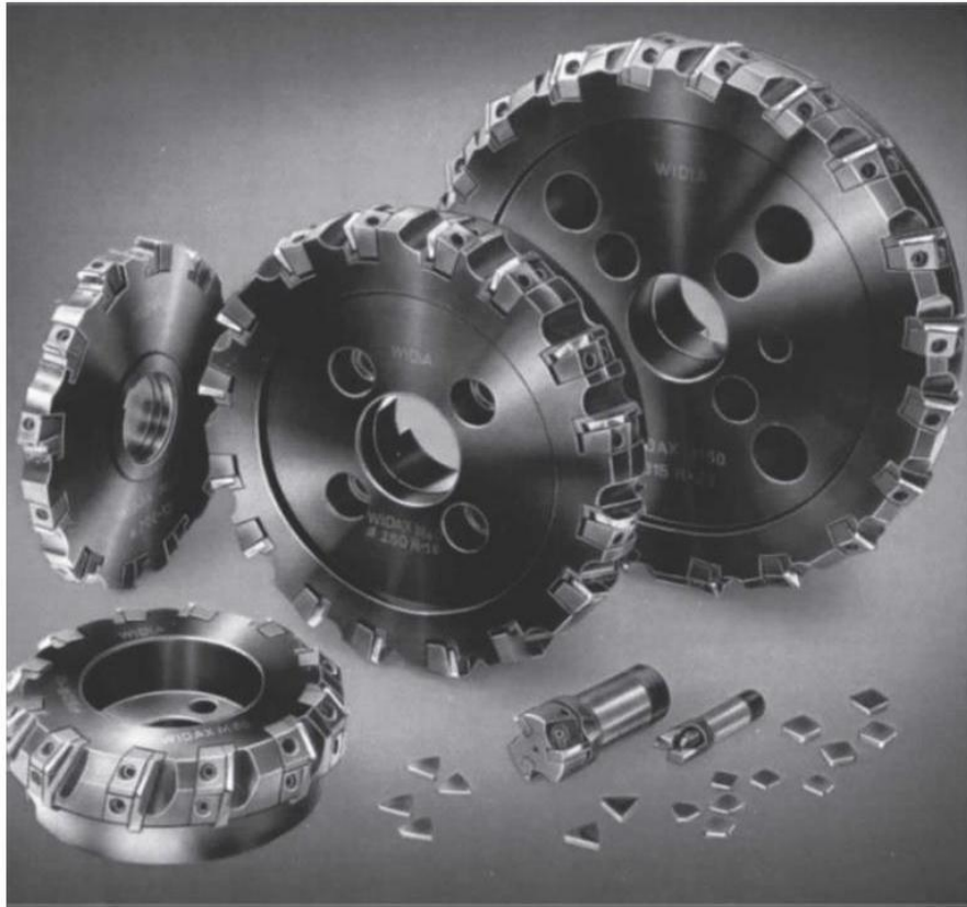
4.16-сурет. Карбидті механикалық қысқыштармен жабдықталған фрезерлік кескіштер. (Krupp, Widia, GmbH, Эссен, Германиядан берілген.)
