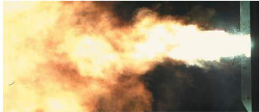
Вспышка дуги может быть очень опасной. Учитывая характер распределения мощности производства живых событий, это очень реальная возможность. Я действительно видел, как это произошло в коммутаторе компании на 400 ампер. К счастью, в этом случае никто не пострадал, но есть и другие люди в индустрии развлечений, которым не так повезло.
