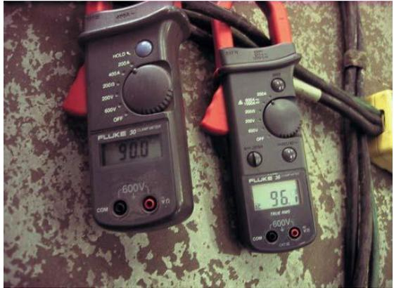
Большинство современных сигналов, с которыми мы сталкиваемся сегодня, не являются чистыми синусоидами. Диммеры, импульсные источники питания и модули с широтно-импульсной модуляцией (как это используется в светодиодах) изменяют форму волны по тому, как они потребляют ток,
