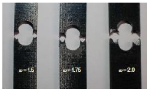
Рис. 7.3 Разрушение соединений при разных соотношениях w/d .
