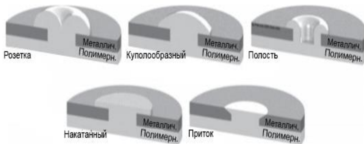
Рис. 9.11 Геометрии шляпки стяга.
