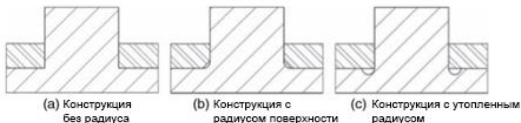
Рис. 9.10 (а) Конструкция без радиус; (б) конструкция с радиусом поверхности; и (с) конструкция с утопленным радиусом.
