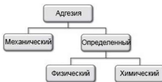
Рис. 4.7 Различные модели адгезии. (Источник: Mitschang et al. 2009 [6]. Воспроизводится с разрешения Издательства SAGE.)
