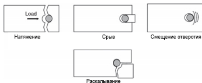
Рис. 7.1 Типовые виды разрушений композитных болтовых соединений
