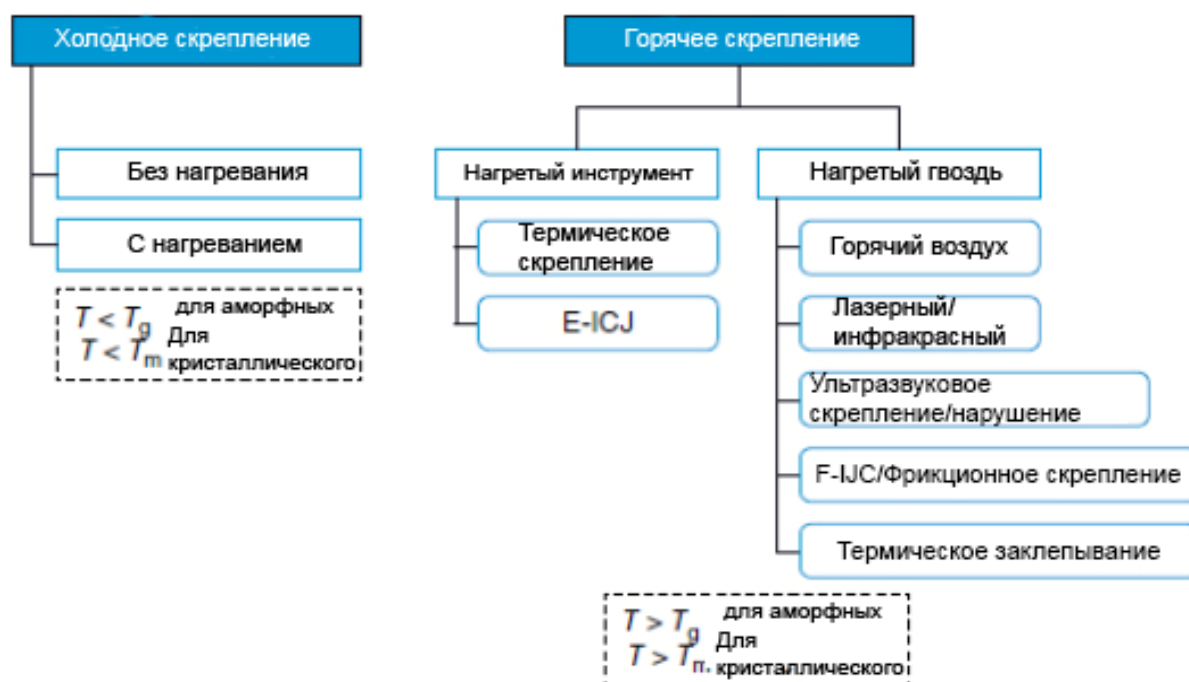
Рис. 9.3 Краткое описание типов процессов скрепления.
