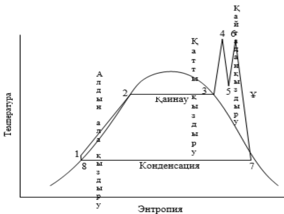
8.7-сурет. Ренкиннің қатты қыздыру және қайтадан қыздыру циклының S-T диаграммасы
