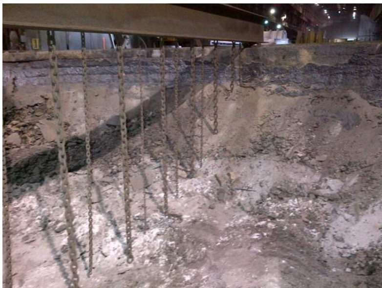
8.15-сурет: ЭДП түбіне арналған өлшеу құралы
