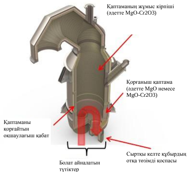
9.49-сурет: РГ вакууматорының құрылымы Magnesita Refractories SA компаниясы ұсынған диаграмма
