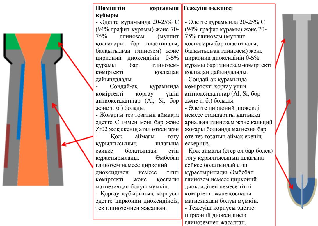
10.14-сурет: Шөміштің қорғаныш құбыры
