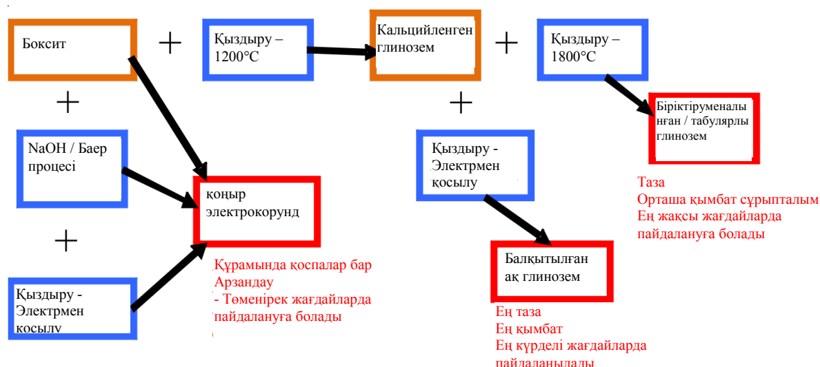
3.24-сурет: Глинозем негізіндегі әртүрлі агрегаттарды өндірудің технологиялық схемасы және оны қолдану
