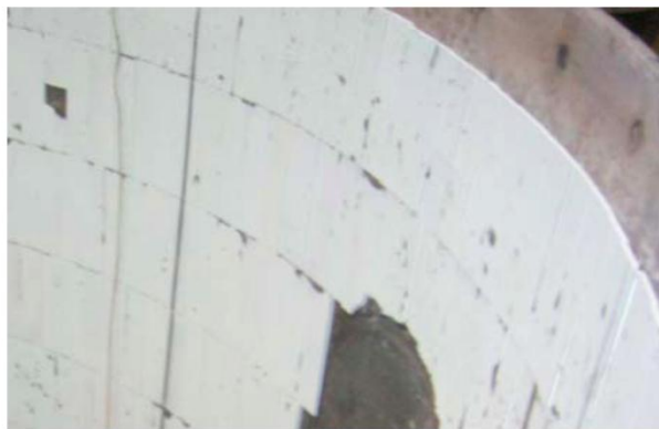
9.9-сурет: Қорғаныш қаптаманың шөміште орнатылған оқшаулағыш тақтасы
