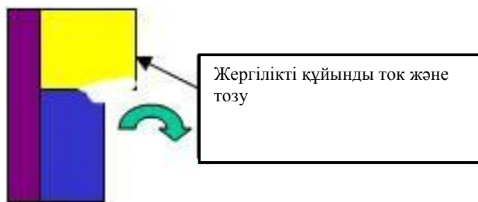
1.15-сурет: Материалдың әртүрлі қалыңдығынан болған жергілікті тозу
