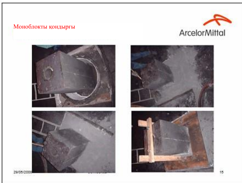
7.33-сурет. НОК төлкесін ауыстыру кезеңдері
