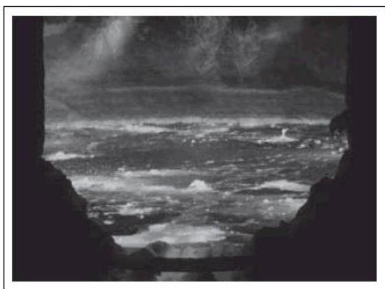
8.29-сурет: 10 л/мин ағын жылдамдығымен ваннаны аргонмен араластыру
