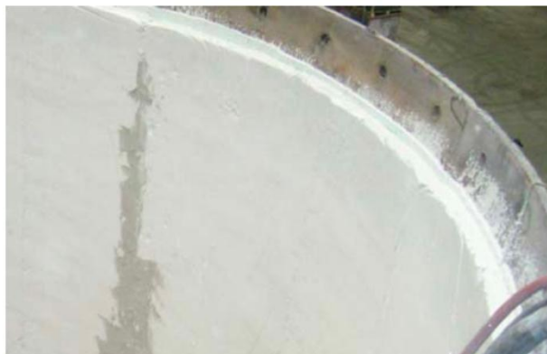
9.9-сурет: Қорғаныш қаптаманың шөміште орнатылған оқшаулағыш тақтасы
