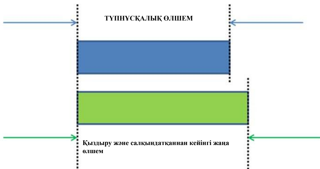
5.16-сурет: Жылулық кеңеюді отқа төзімді материал үлгісінде өлшеу
