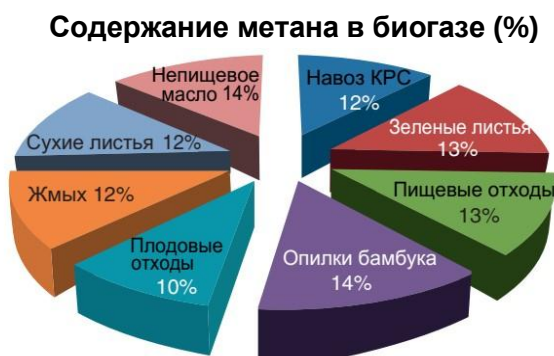
Рисунок 6.4 Содержание метана в биогазе из различных отходов [23, 24].
