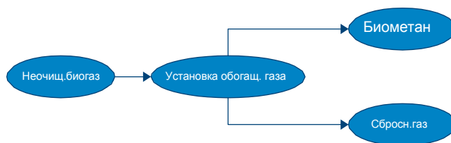
Рисунок 12.2 Основная технологическая схема разделения биометана.
