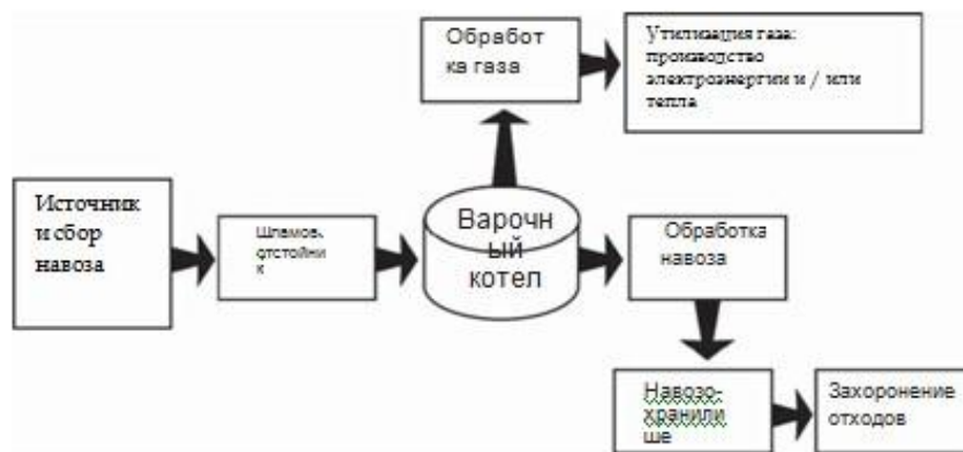
Рисунок 12.4 Основная схема потока материалов в производстве биогаза.
