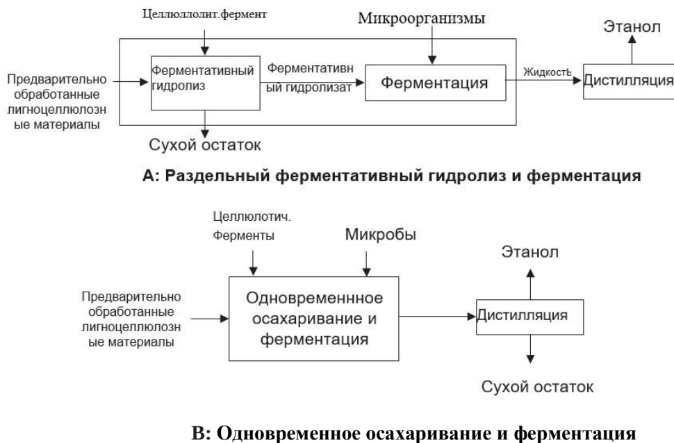
Рисунок 8.8 Основные этапы производства SSF или SHF для производства этанола.
