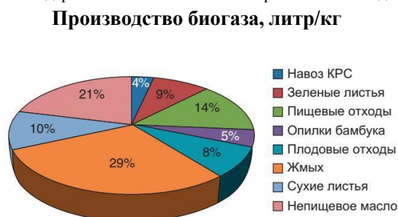
Рисунок 6.5 Возможность производства биогаза из различных отходов [23, 24].
