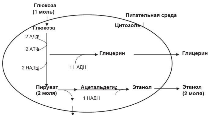
Рисунок 8.5 Основной метаболический путь дрожжей в анаэробных условиях.
