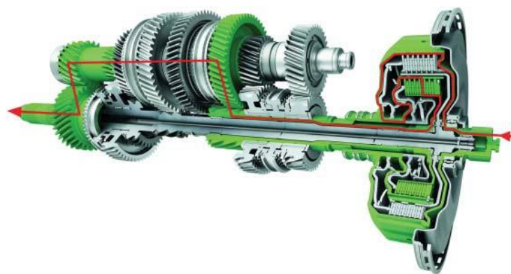
17.5-сурет Екі осьтік аралық біліктері бар ілінісі қосарлы трансмиссия; екінші беріліс іске қосылған (Dr. Ing. h. c. F. Porsche AG рұқсатымен жаңғыртылған)
