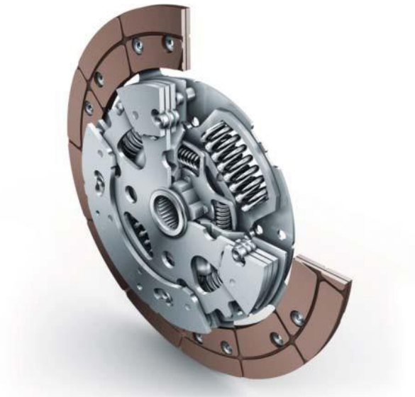
17.6-сурет Бұралу бәсеңдеткішімен және орталықтан тепкіш маятниктің амортизатормен ілінісу дискісі (Schaeffler рұқсатымен жаңғыртылған)
