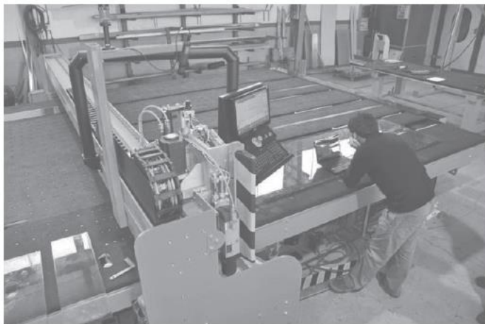
Рисунок 14.1. Машина для резки ламинированного стекла. (Фото любезно предоставил TUROMAS.)
