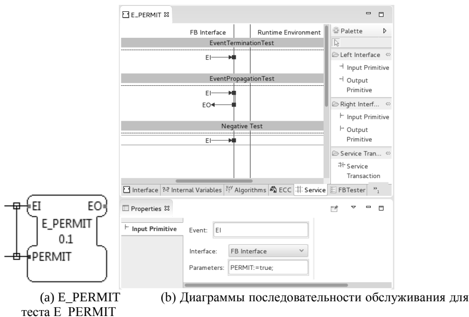
Рисунок 7.5. Стандартная библиотека IEC 61499 FB E_Permit и ее тестовая спецификация с 4DIAC
