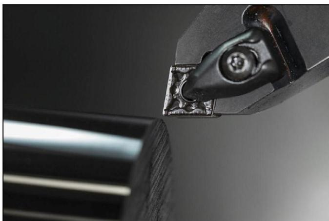
РИСУНОК 7-6: 0-градусный алмазный токарный резец. Как и все прецизионные инструменты, рычажным инструментам следует дать немного любви и заботы для лучших результатов обработки. С разрешения: Сандвик Коромант (Sandvik Coromant)
