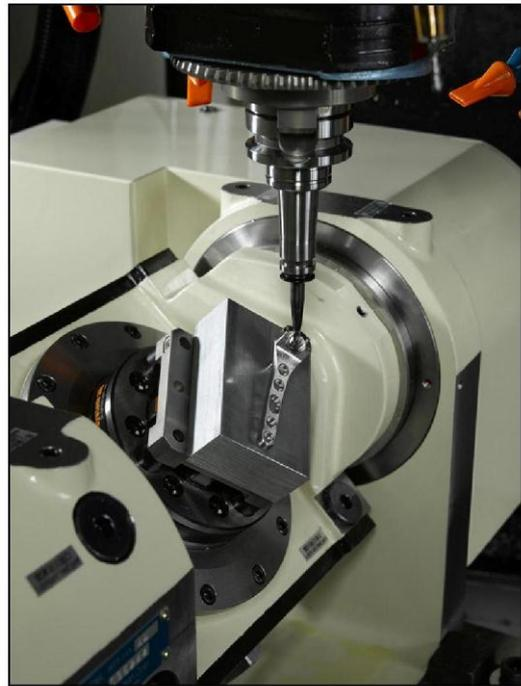
РИСУНОК 2-4: Поворотный стол – второе лучшее изобретение к пятикоординатному многоцелевому станку. Обратите внимание на дизайн «поворотный стол на поворотном столе» осей A и B. С разрешения: Корп. ФАНУК Америка (FANUC America Corp)
