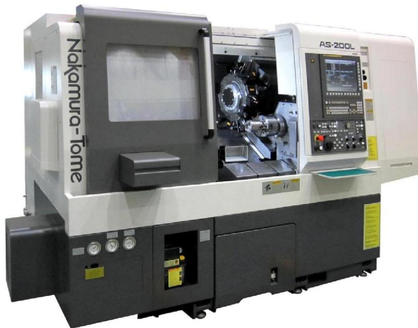
РИСУНОК 2-5: Этот двухкоординатный токарный станок снабжен контршпинделем вместо задней бабки, что позволяет обрабатывать оба конца детали в одной настройке. С разрешения: Накамура-Томе (Nakamura-Tome)
