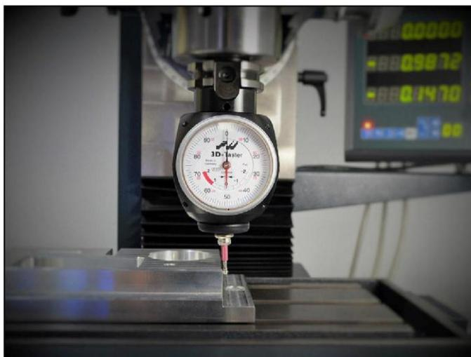
Рисунок 8.3. Этот трехмерный универсальный датчик разделал в пух и прах устаревший вигглер, и может использоваться для сбора рабочих координат, измерений размера деталей, проверок плоскостности и прямолинейности, и т.д.
