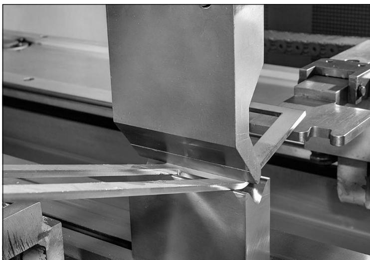
РИСУНОК 3-6: Гибочный пресс производит сложные изгибы в листе металла.
