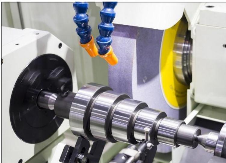
РИСУНОК 3-3: Цилиндрическое шлифование является одним из наиболее точных процессов обработки.
