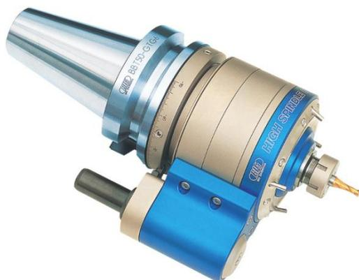
РИСУНОК 14-2: При скорости обработки поверхности 500 фут/мин, (СОП) для 1/8-дюймового резака требуется почти 16 000 об./мин., а для 1/16-дюймового инструмента - вдвое больше, что намного превышает возможности большинства многоцелевых станков. Решением является ускорительная головка, которая в зависимости от марки и модели, может легко достигать скорости шпинделя 50 000 об/мин или выше (часто намного выше).
