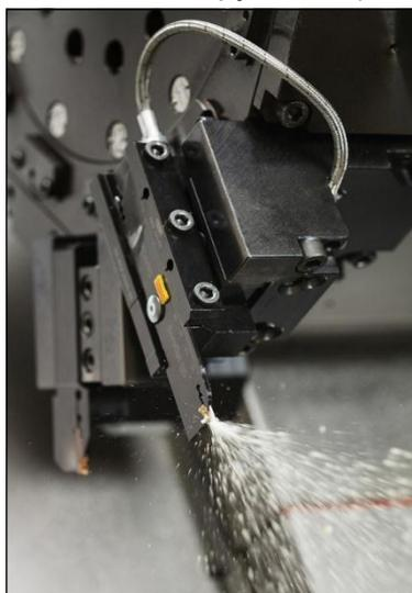
РИСУНОК 12-3: Отдавайте предпочтение инструментам, где СОЖ (желательно под высоким давлением) подается через инструмент, когда это возможно
