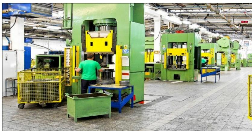
РИСУНОК 3-7: Штамповочные машины, подобные этим, используются для обрезки и формирования частей
