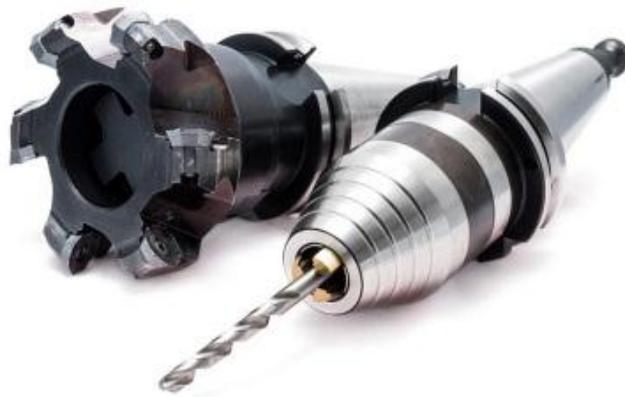
РИСУНОК 7-1: Слева индексируемая торцевая фреза, окруженная сверлильным патроном без ключа. Каждая монтируется на держатель типа CAT 40. Сверху справа показана захватная головка, крепящая инструмента в шпинделе станка.
