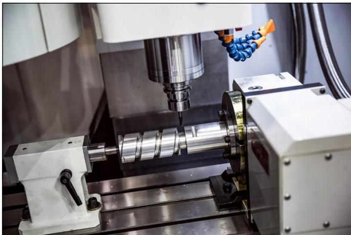
РИСУНОК 8-1: Поворотные столы – один из самых популярных из всех приспособлений ВМС.
