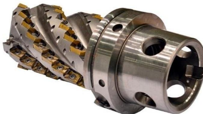
РИСУНОК 12-4: При наличии свободного места фрезерный станок - это экономичный способ быстрого удаления большого количества материала.
