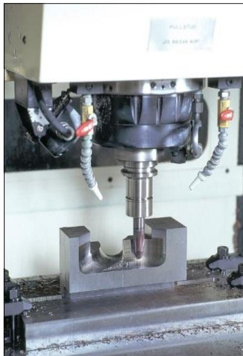
РИСУНОК 6-6: Иногда самое простое решение - самое целесообразное. В этом случае заготовка была прикреплена непосредственно к верстаку станка, что исключало необходимость в тисках или зажимном устройстве. С разрешения: Биг Кайзер (BIG KAISER)
