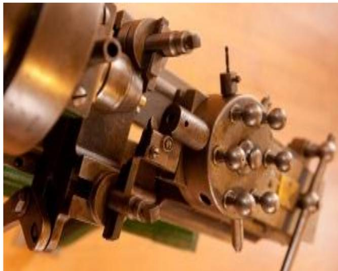
РИСУНОК 1-5: Этот токарно-револьверный станок 1861 года от Лэмсон Гудноу и Ко. имеет много общего с оригинальной конструкцией токарно-винторезного станка Модслей. Если Вы хотите увидеть это лично, отправляйтесь в Американский музей точности в Виндзоре, штат Вермонт и скажите, что Вас послал Кип.
