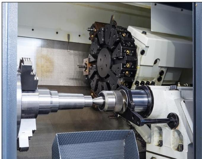
Рисунок 6-3: Вал на двуосном станке с ЧПУ. Слева трехкулачковый механизированный патрон с закаленными верхними кулачками, зажимает заготовку, удерживаемую задней бабкой.
