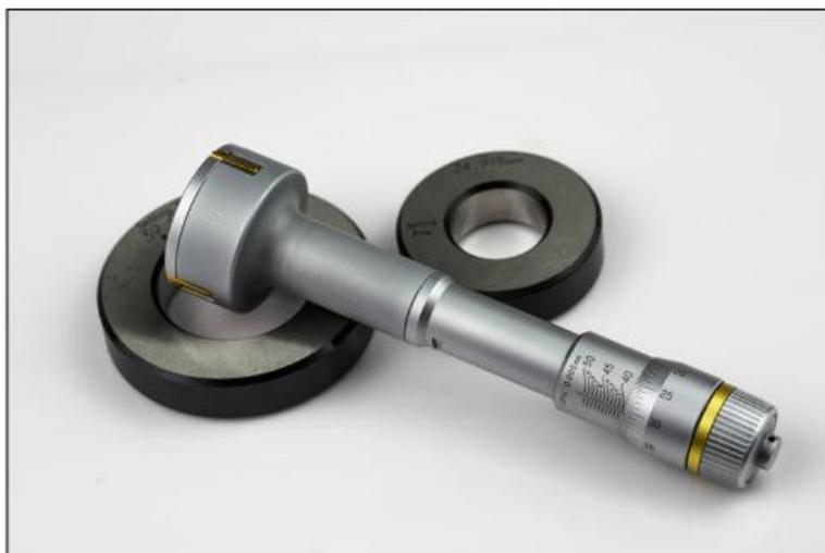
Рисунок 10-3: Из всех видов внутренних микрометров тройной, показанный на этом рисунке, является наиболее гибким и простым в использовании.
