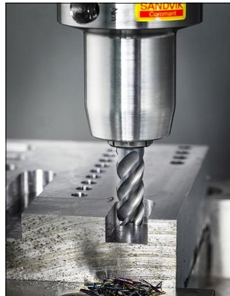
РИСУНОК 5-3: Концевая фреза с 4-канавками нарезает паз в заготовке из углеродистой стали.
