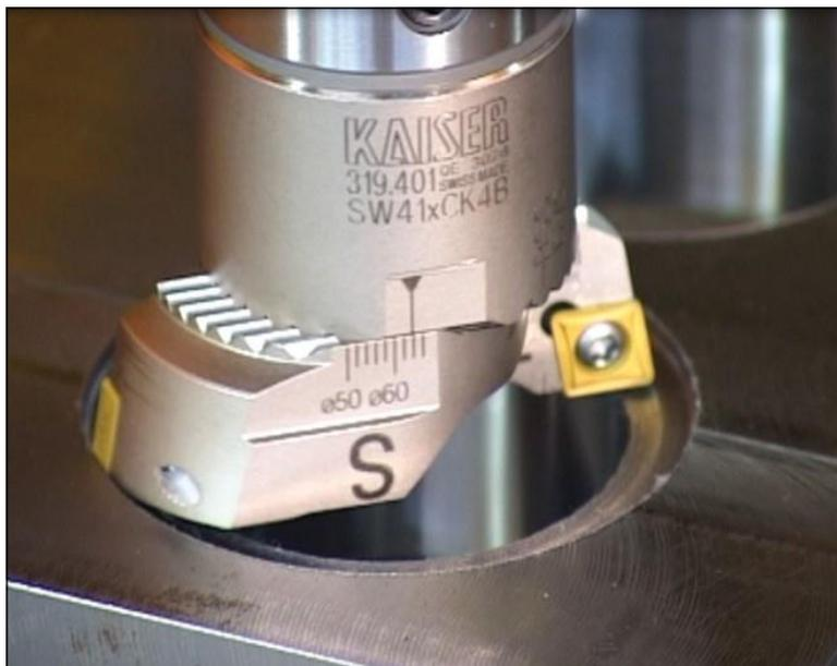
РИСУНОК 12-5: Шаговая расточка с помощью регулируемого инструмента с двумя головками. Обратите внимание, что общее количество материала, подлежащего удалению одной вставкой, сокращается примерно пополам
