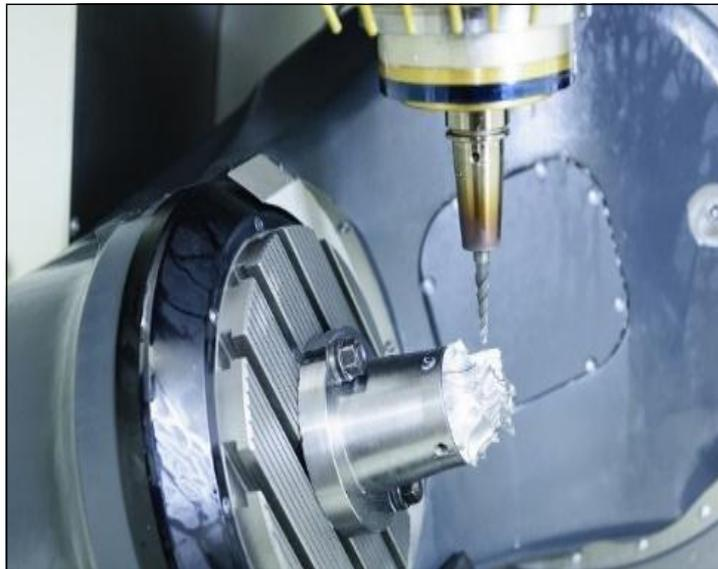
РИСУНОК 6-5: Пятикоординатным многоцелевым станкам необходимы тиски и зажимные приспособления для обеспечения достаточного зазора.
