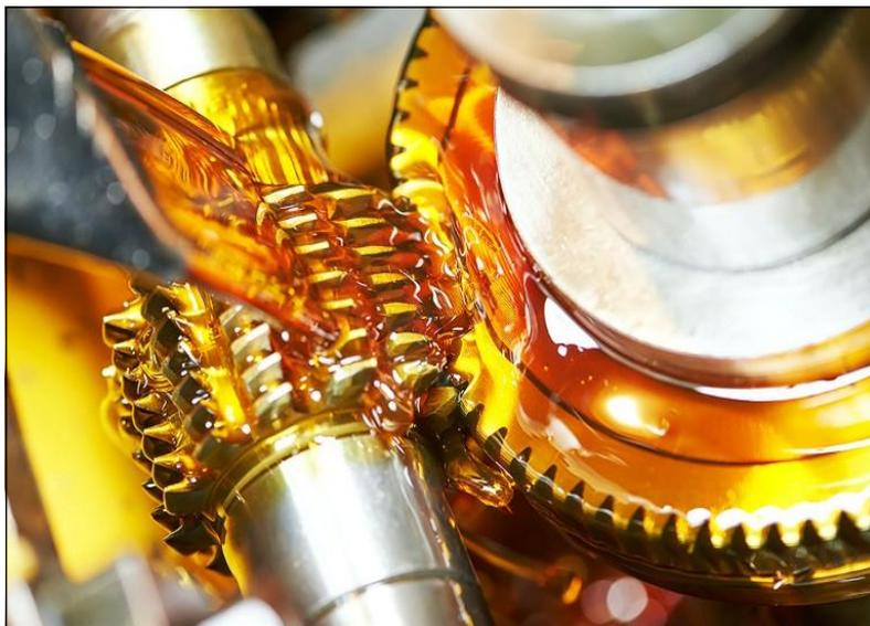
РИСУНОК 3-5: Нарезание червячной фрезой является важным процессом при производстве высокоточных шестерен
