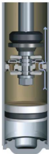
Рисунок 18.2 Однотрубный амортизатор: детали потока для сжатия (воспроизведено с разрешения ZF Friedrichshafen AG)
