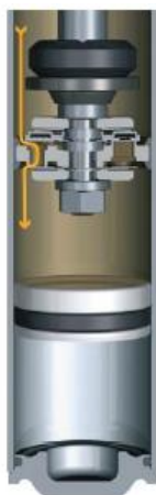
Рисунок 18.3 Однотрубный амортизатор: детали потока для обратного хода (воспроизведено с разрешения ZF Friedrichshafen AG)
