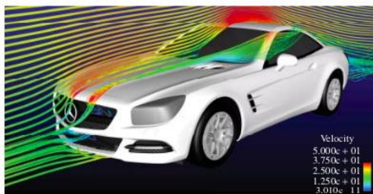
Рисунок 3.3 Вихрь в моторном отсеке и на рулевой колонке (продублировано с разрешения Daimler AG)
