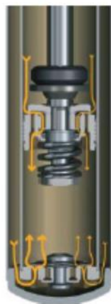
Рисунок 18.6 Двухтрубный амортизатор: детали потока для обратного хода (воспроизведено с разрешения ZF Friedrichshafen AG)
