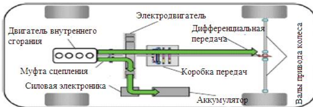
Рисунок 7.3 Разделение силы от двигателя внутреннего сгорания
