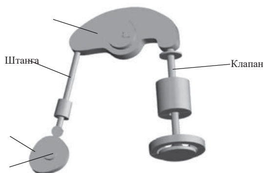
Рисунок 20.11 Привод клапана коромыслового рычага (пример из программного обеспечения MBSADAMS)
