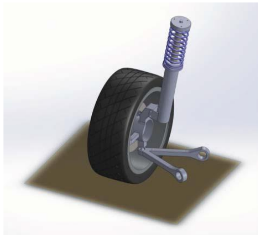
Рисунок 16.6 Основные компоненты подвески передней оси McPherson
