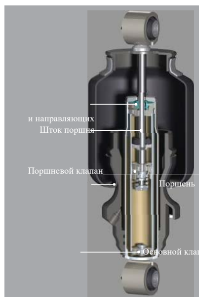
Рисунок 18.18 Пневматическая пружина без дополнительного объема (воспроизведено с разрешения ZF Friedrichshafen AG)
