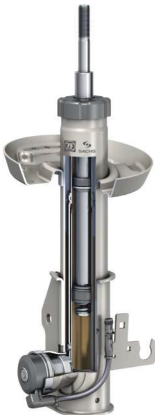
Рисунок 18.12 Амортизатор CDC (воспроизведено с разрешения ZF Friedrichshafen AG)
