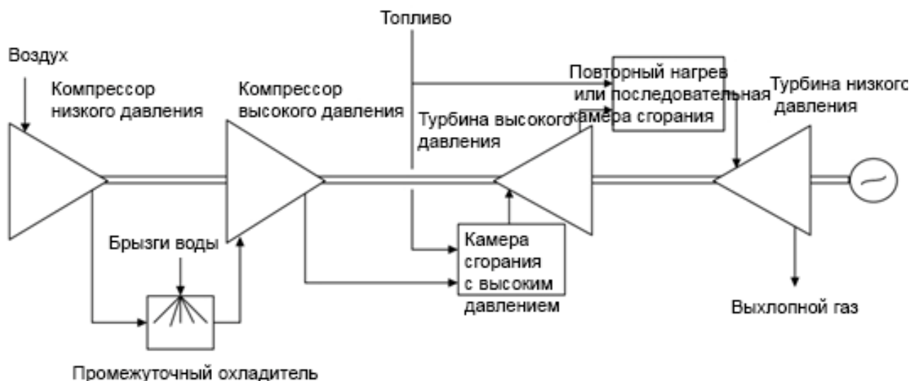
Рисунок 9.2 Стадии повторного нагрева и промежуточного охлаждения распылением в газовой турбине
