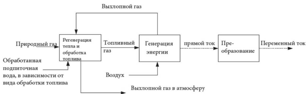
Рис. 1.5 Схема системы с топливными элементами на природном газе
