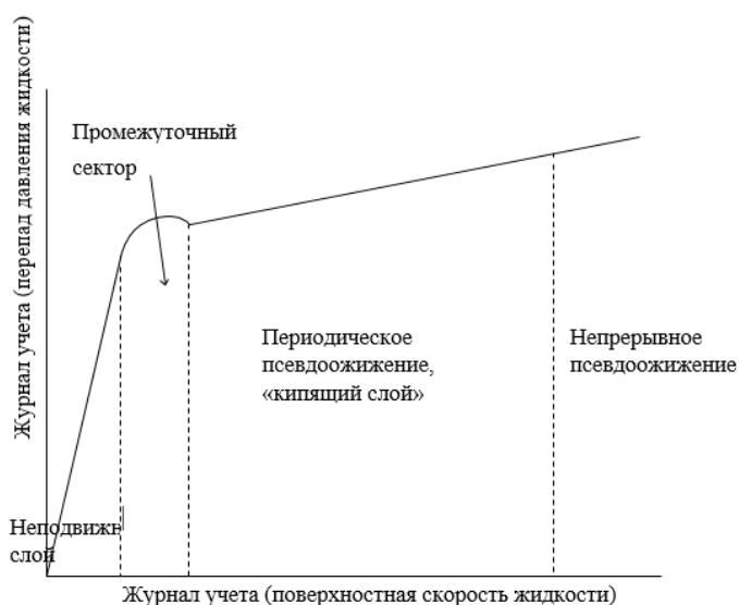
Рисунок 3.1 Перепад давления и режимы потока в жидкости с твердыми частицами
