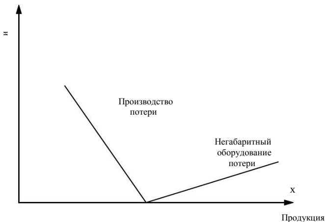
Рисунок 7.5. Потери против отобранной продукции конвейера.
